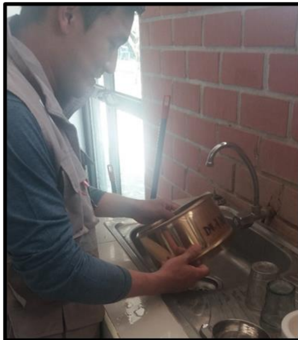
Imagen – 06: Se observa al tesista lavando la muestra, después de haberse realizado el tamizado por granulometría.
