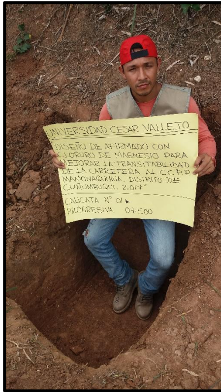
Imagen – 01: Extracción de muestra calicata N°01.
