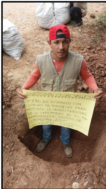
Imagen – 02: Extracción de muestra calicata N°02.
