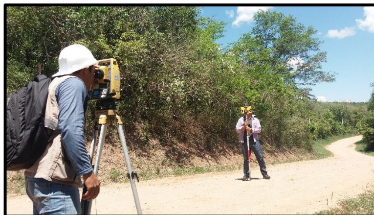
Imagen – 03: Se observa la toma de datos en el primer tramo con la estación total.
