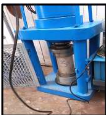
Figura 37 Vista de rotura de probetas Testigo N°3.
