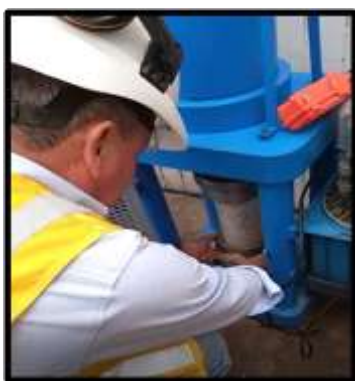
Figura 36 Vista de rotura de probetas Testigo N°2.
