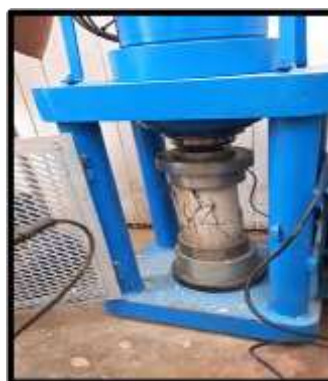
Figura 36 Vista de rotura de probetas Testigo N°2.
