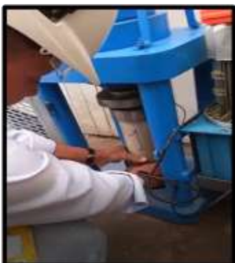
Figura 35 Vista de rotura de probetas Testigo N°1.
