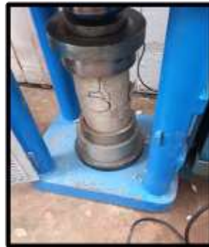
Figura 39 Vista de rotura de probetas Testigo N°5.
