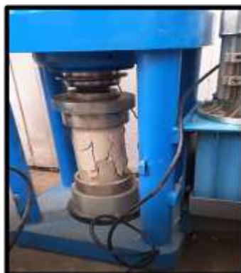
Figura 35 Vista de rotura de probetas Testigo N°1.
