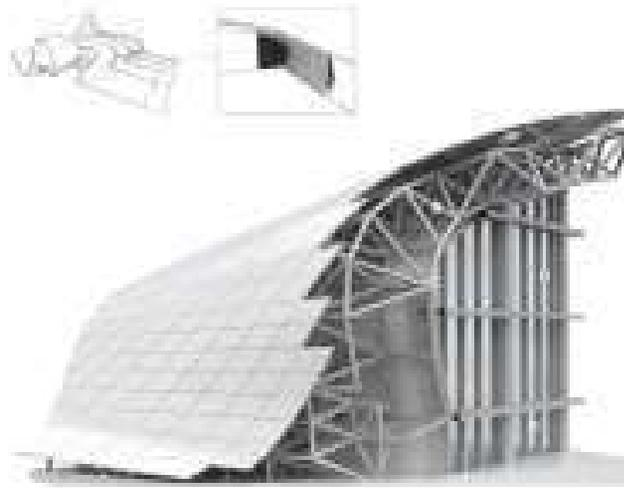
La propuesta nace a partir de una malla que se empieza a configurar por las diferentes columnas, seguido por un esqueleto de acero para que finalmente entre el caparazón, que será el punto clave que una todo el equipamiento en una forma dinámica pero versátil a la vez.
