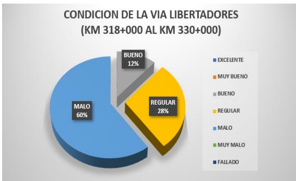
Figura N°32. Porcentajes de condición del pavimento flexible en la vía Libertadores (KM 318+000 AL KM 330+000)
