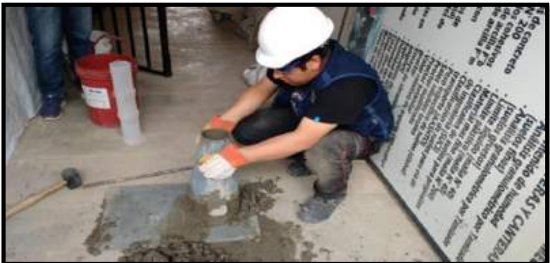
FIGURA N°02. Preparación de la muestra para la prueba de asentamiento (slump)
