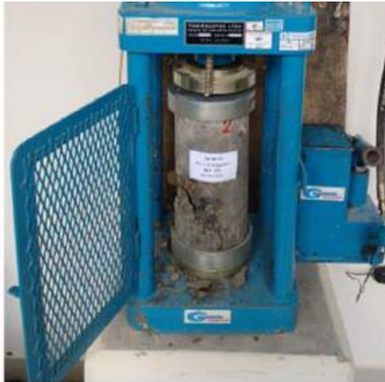
FIGURA N°05. Rotura de briquetas
