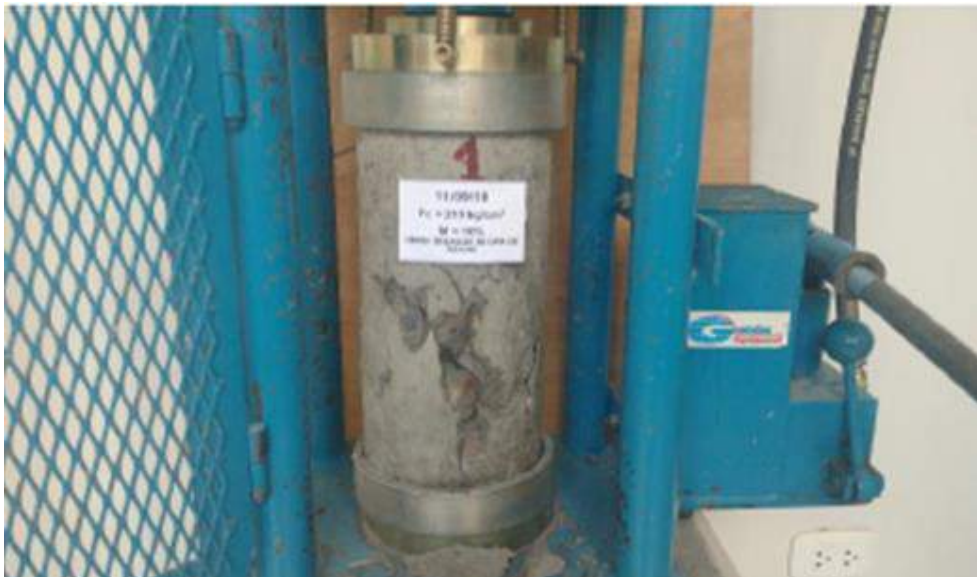
FIGURA N°08. Rotura de probetas 10% CBCA
