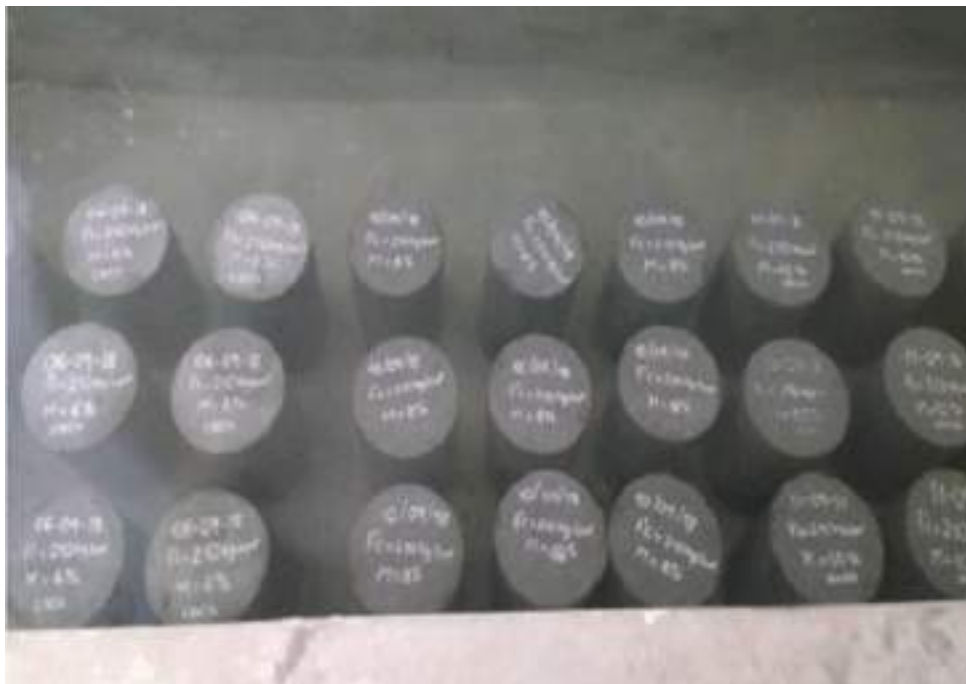
FIGURA N°04. Curado de la probetas cilíndricas de concreto
