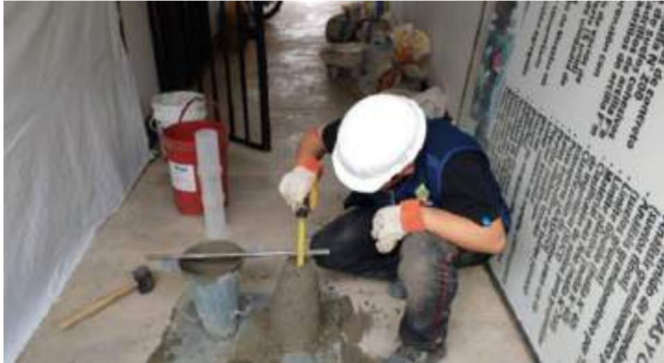
FIGURA N°03. Medición asentamiento (slump)
