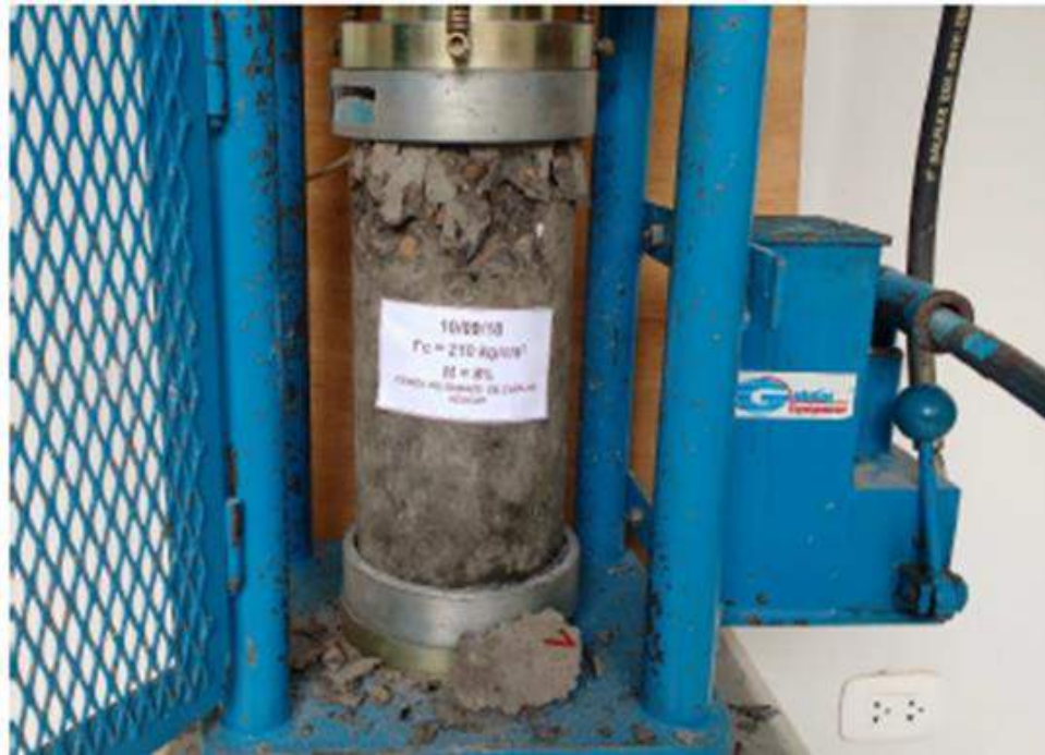
FIGURA N°07. Rotura de probetas 8% CBCA
