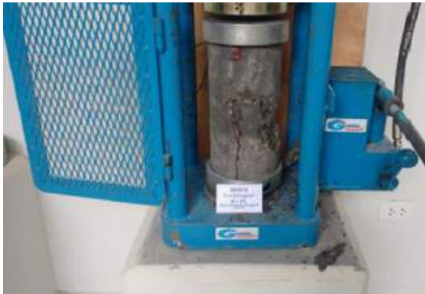
FIGURA N°06. Rotura de probetas 6% CBCA
