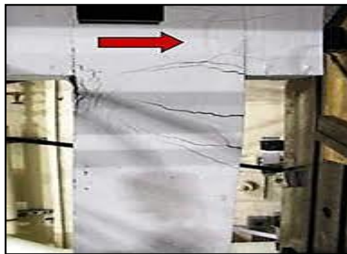
Figura. 02. Falla por flexión
