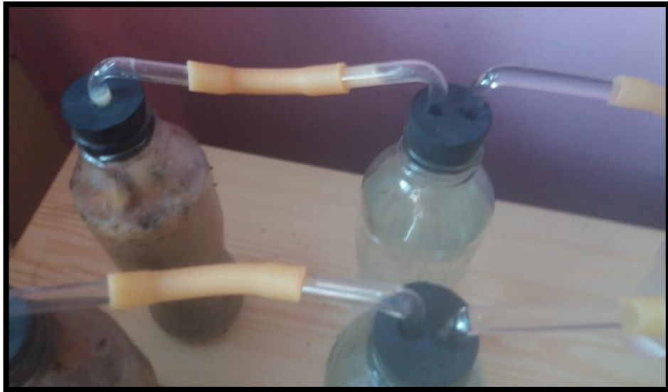
Conexiones para la conducción del biogás.
