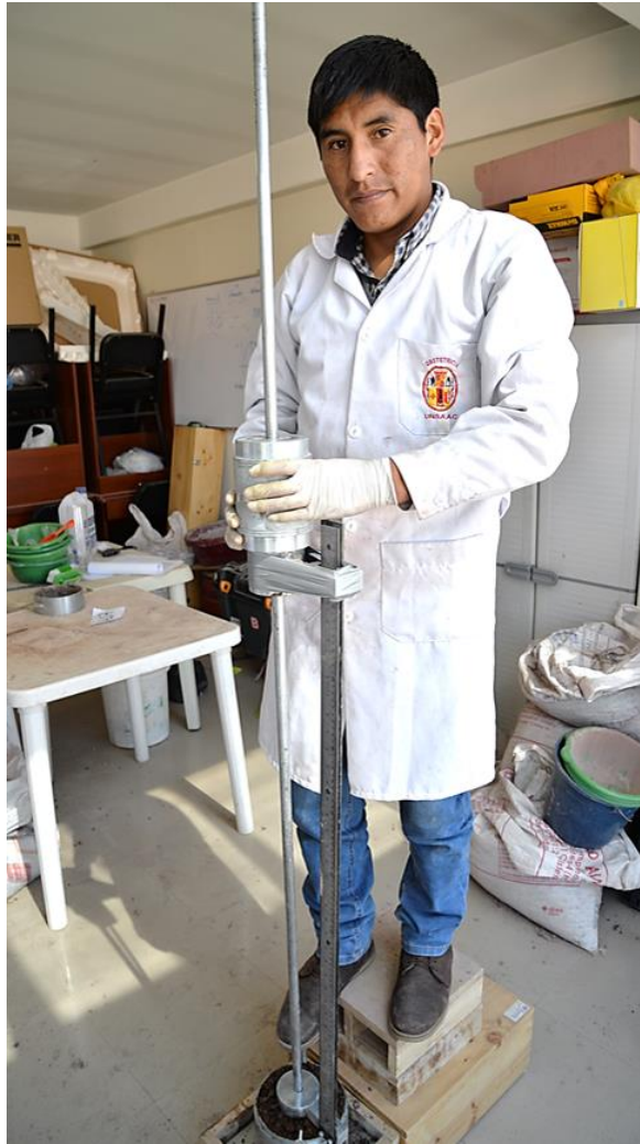
Figura 20. Medición del CBR con el método PDC.
