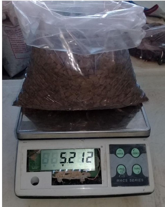
Figura 34. Se observa el pesado de la muestra de la cantera.
