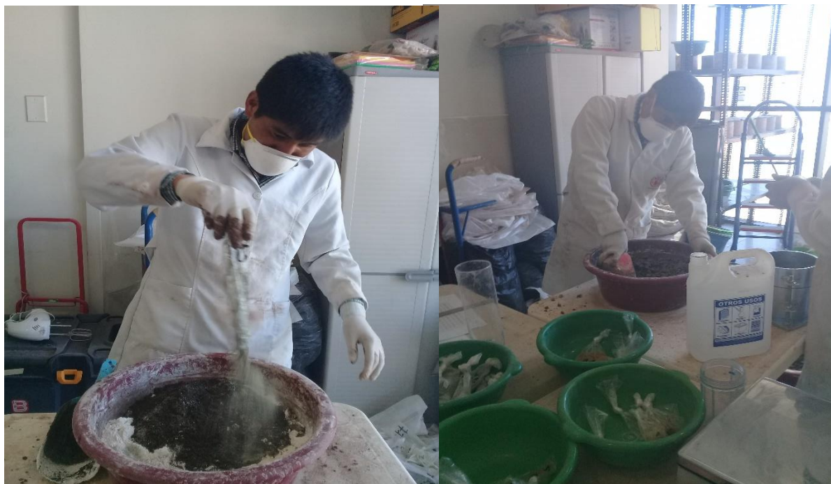
Figura 37. Se observa el mezclado de material de cantera y aditivos consolid y solidry.
