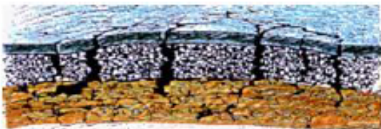
PAVIMENTO CON SISTEMA TRADICIONAL
