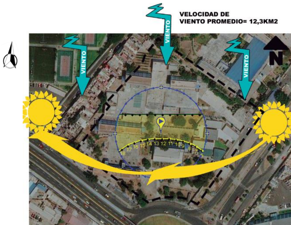
FIGURA 11. DIRECCIÓN DEL VIENTO EN EL TERRENO
