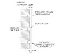
DETALLE 1 Muro de Alambra
