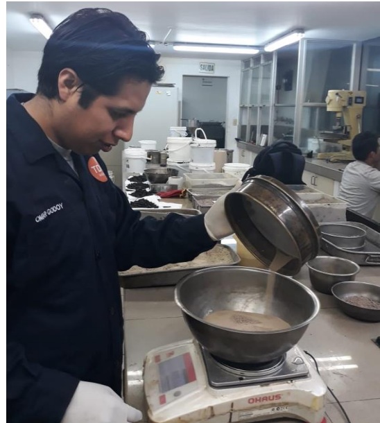
Análisis granulométrico de agregados
