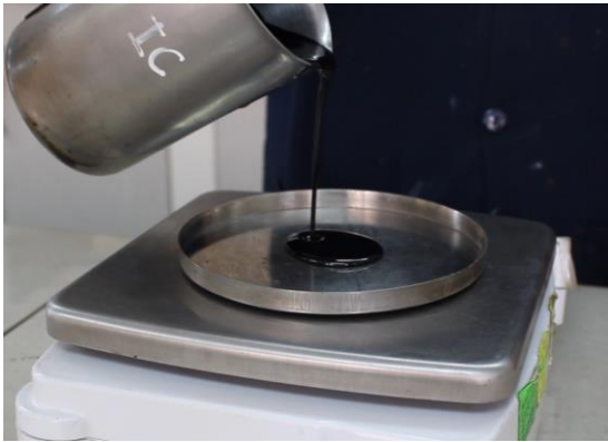
Envejecimiento de asfaltos en horno PAV
