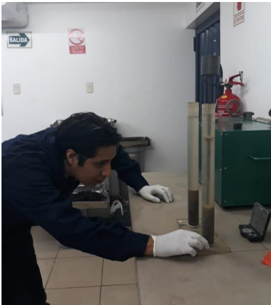
Ensayo de equivalente de arena
