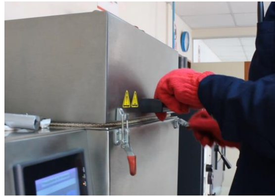
Envejecimiento de asfaltos en horno PAV
