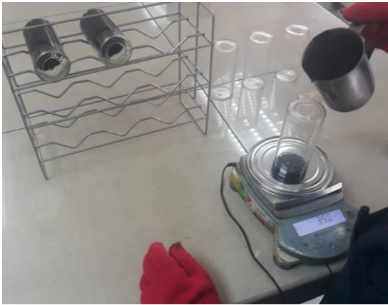
Envejecimiento de asfaltos en horno RTFOT
