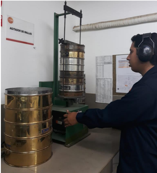
Análisis granulométrico de agregados
