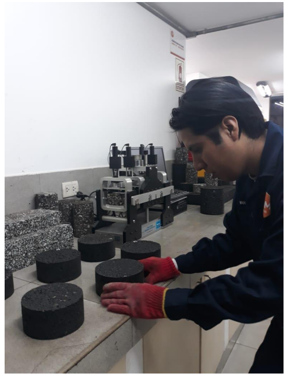
Elaboración de especímenes para ensayo de Rueda de Hamburgo
