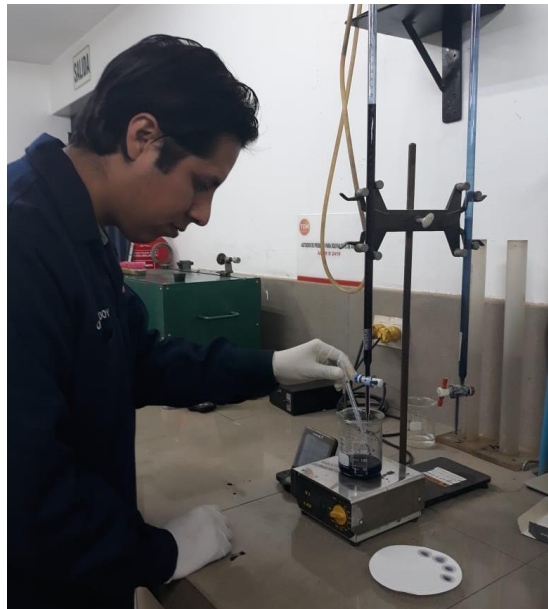
Ensayo de Azul de metileno
