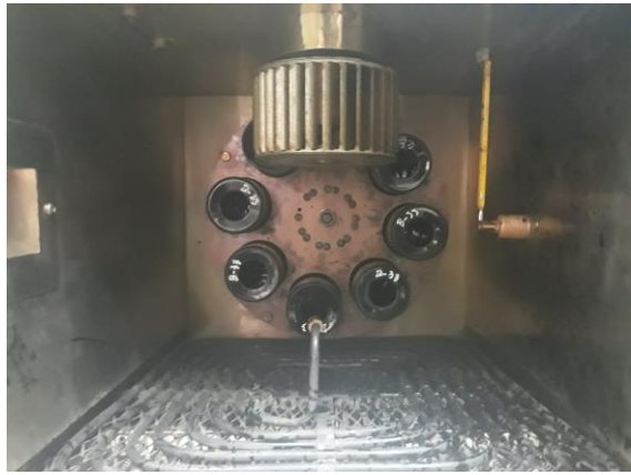
Envejecimiento de asfaltos en horno RTFOT
