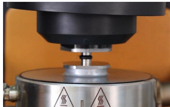
Evaluación de la rigidez del asfalto a temperatura intermedia
