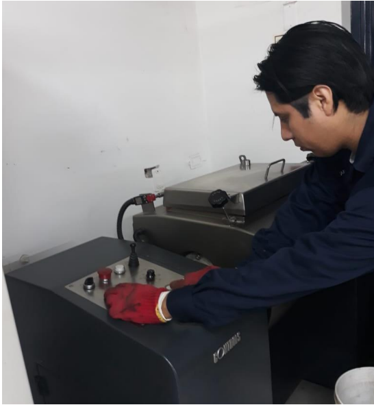
Elaboración de mezclas asfálticas en mezclador automático
