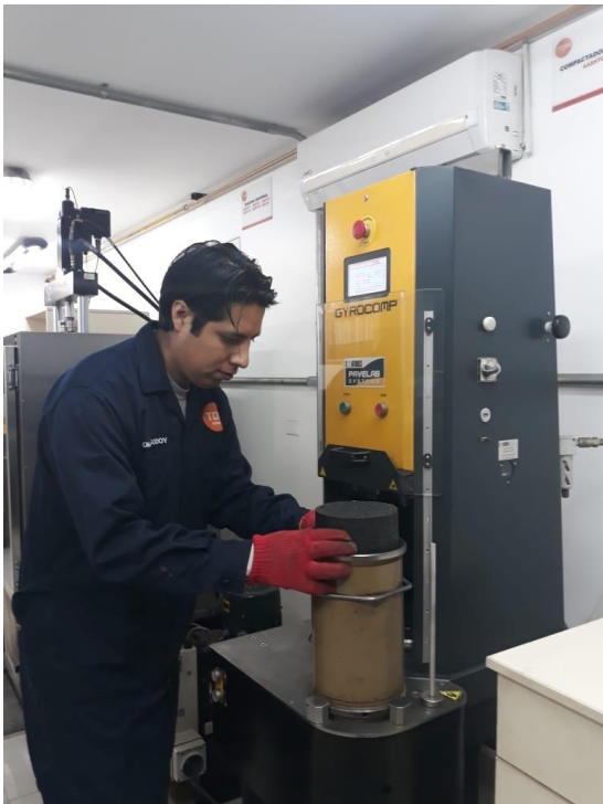
Elaboración de especímenes para ensayo de Rueda de Hamburgo
