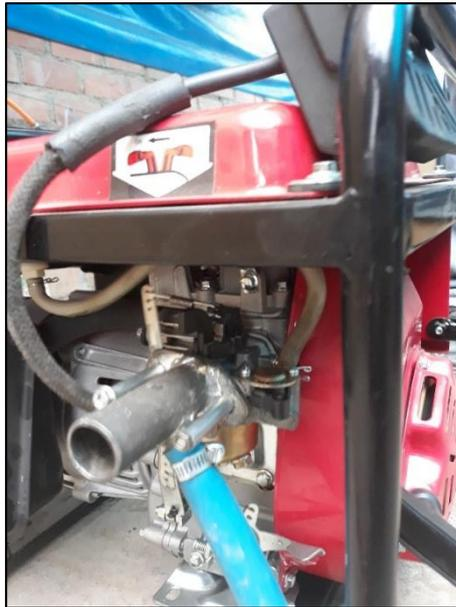
*Fotografía 12: Mezclador (conversión a biogás del grupo electrógeno) en la entrada del carburador*
