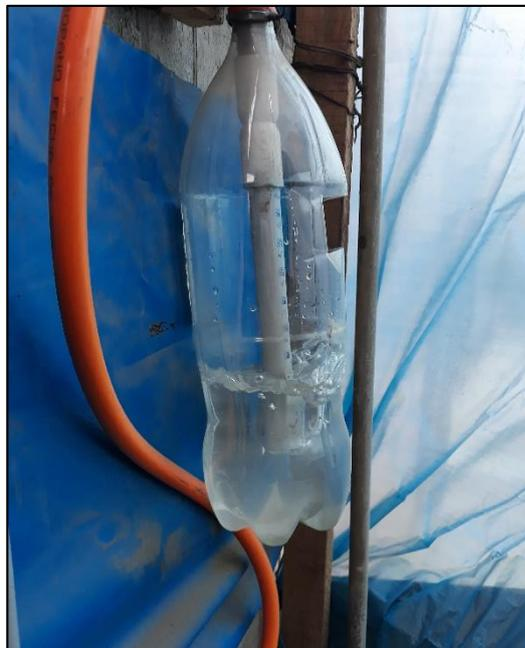
*Fotografía 9: Válvula de alivio casero y el burbugeo indicando presencia de gases*
