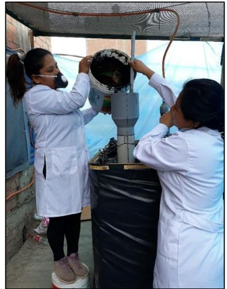
*Fotografía 8: Cargado interdiario del biodigestor*
