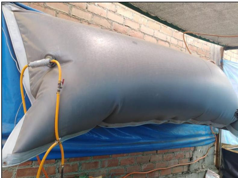
***Fotografía 11: Biogás obtenido en condiciones anaeróbicas con lodos***
