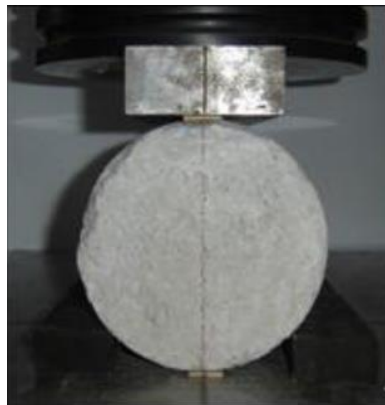
Figura 22. Cálculo de la resistencia a compresión diametral o tracción indirecta
