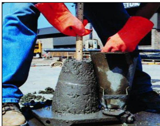
Figura 12. Ensayo de Asentamiento
