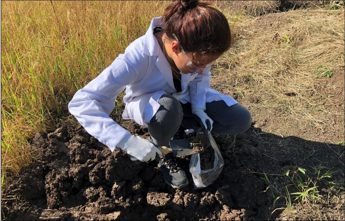
Muestreo para determinar la concentración de cadmio (muestreo de identificación)
