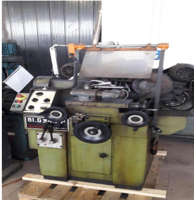
Figura N°4: Rectificador de discos en mal estado
