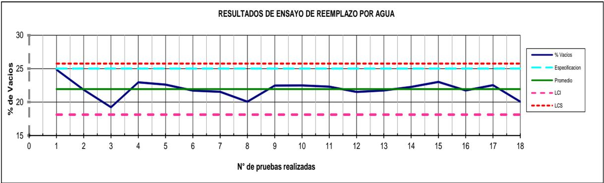
Figura 17 Control de porcentaje de vacíos (ensayo del 01 al 018)
