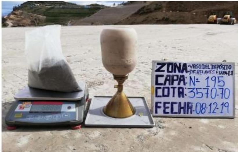
**Foto 16:** Se realizó ensayos de densidad método cono de arena.
