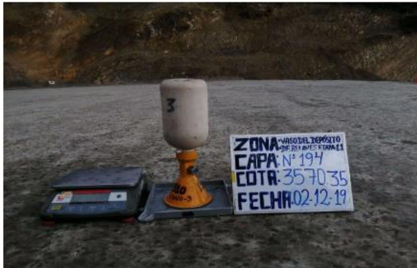
**Foto 3:** Se realizó ensayos de densidad método cono de arena en la cota 3570.35 msnm.
