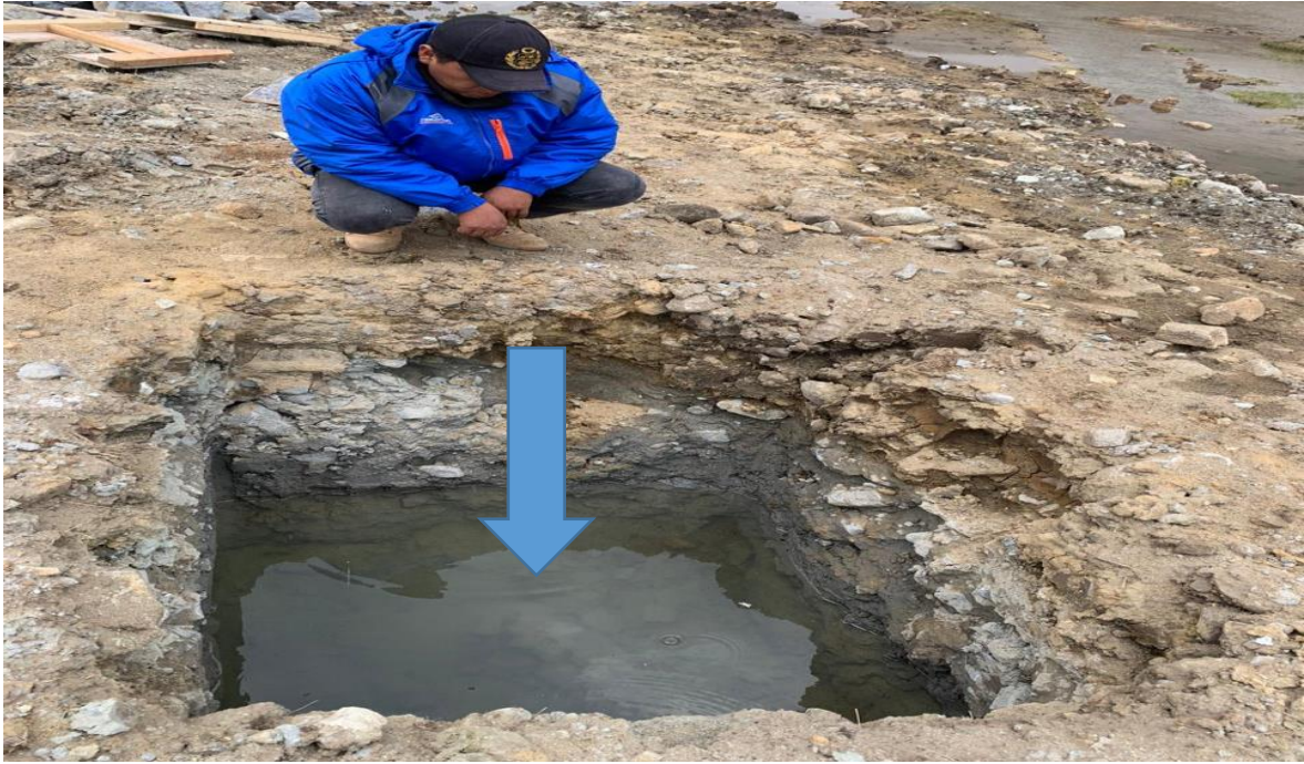
Figura 37. Vista de una excavación en la zona de la cerrada, se observa la presencia de nivel freático casi superficial.
