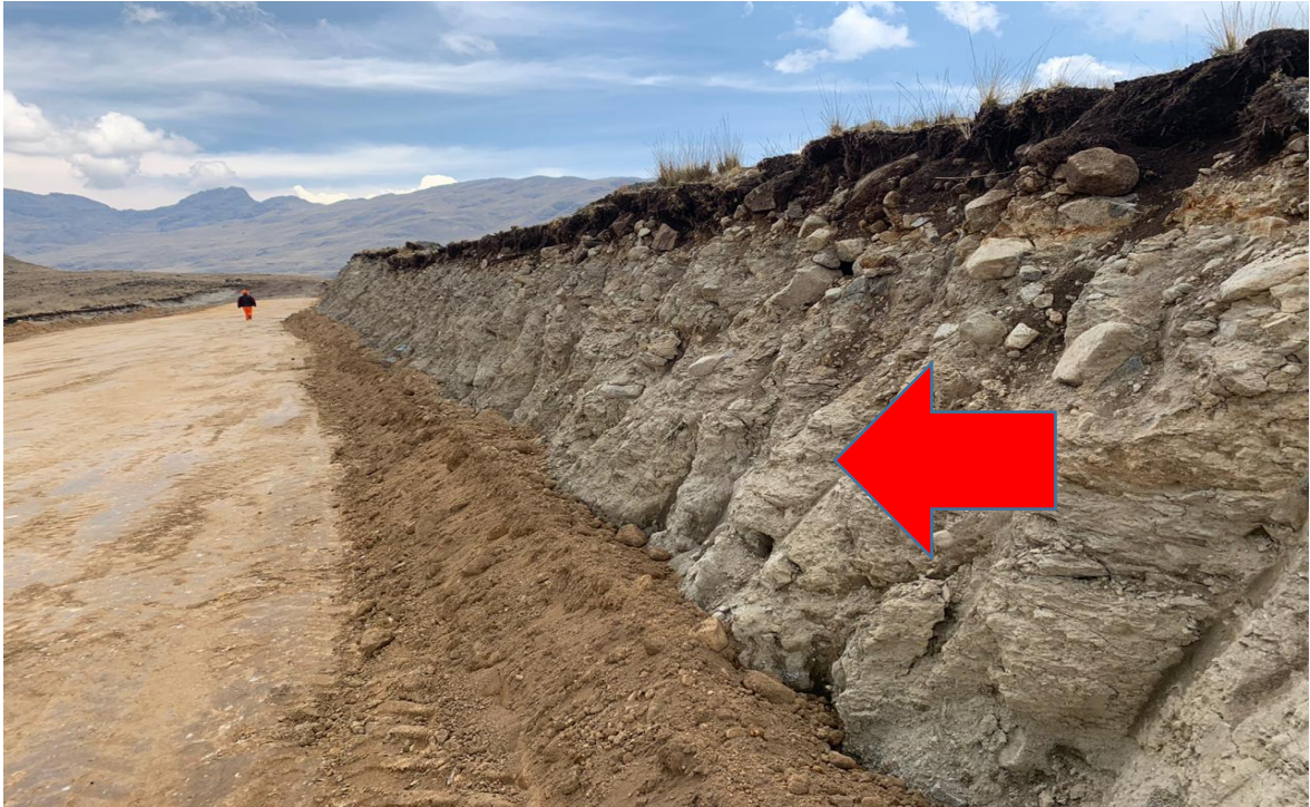
Figura 35. Vista de las estratificaciones de las morrenas, se observa estratos arenosos permeables, depósitos fluvio glaciales.
