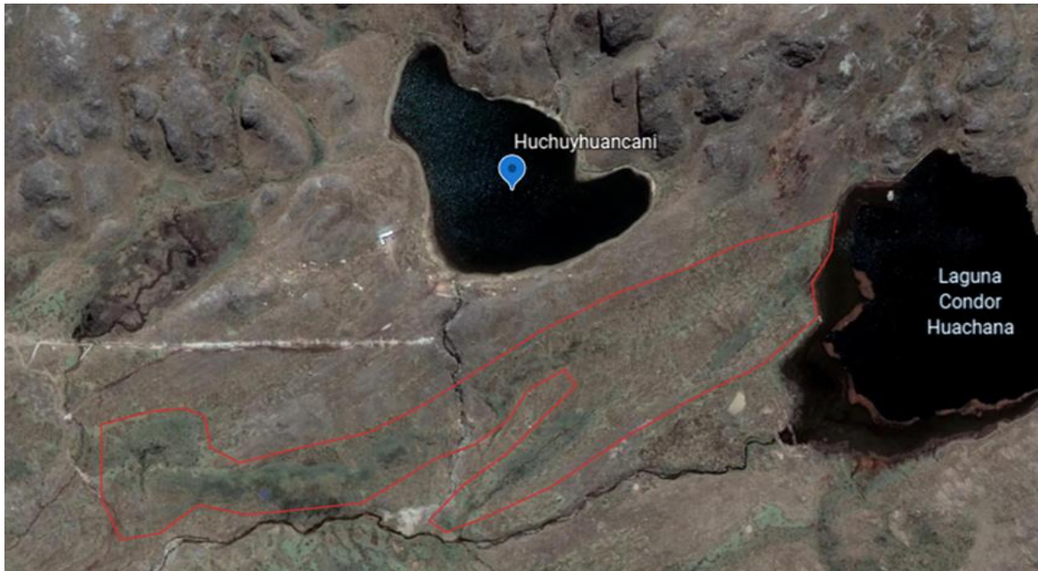
Figura 33. Vista satelital de la laguna de Uchuyhuancani, casi como las filtraciones existentes ladera abajo cuyo origen definitivamente es por las lagunas superiores existentes.
