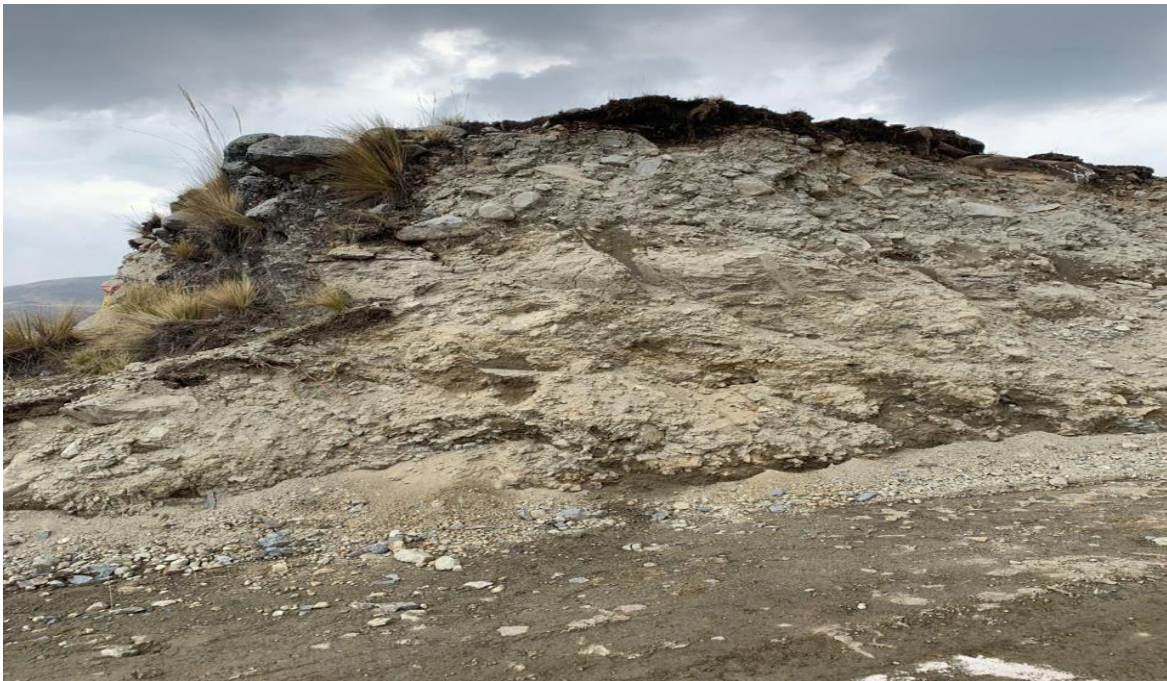
Figura 34. Vista de la zona de excavación en la cantera cerrada del dique, se observa depósitos morrenicos, suelos granulares con finos.
