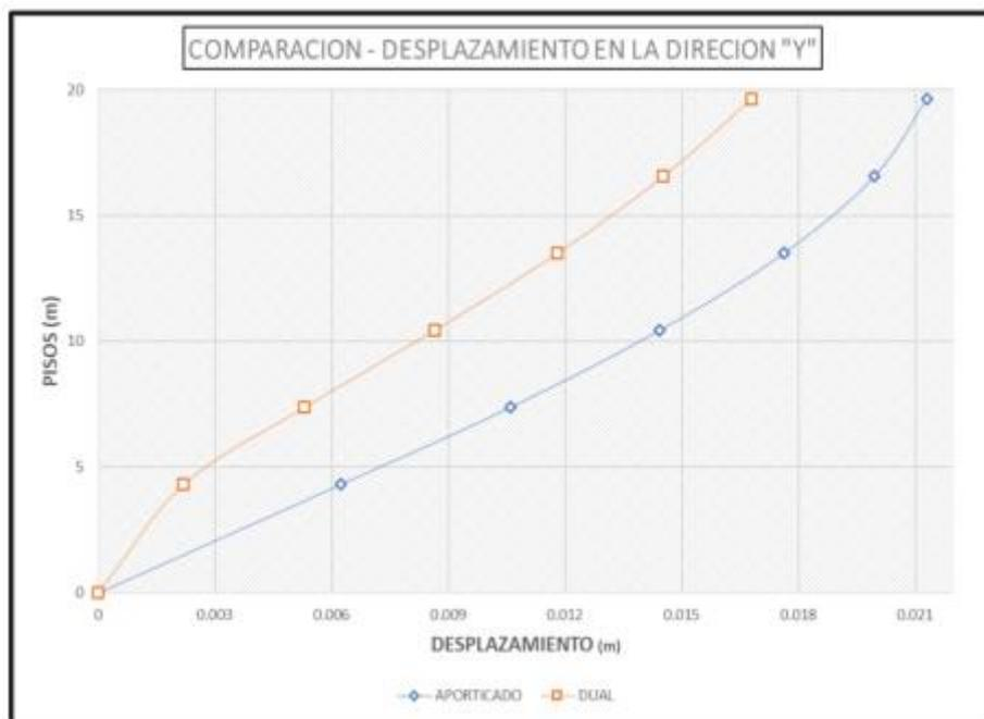
**Figura 97: Comparación – Desplazamientos en Dirección “Y”**
