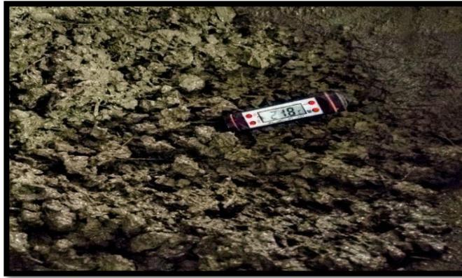
**Figura 12.** Ensayo de temperatura de diseño mezcla con 1 % de paja de trigo.
