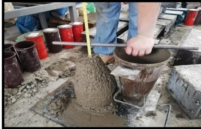
**Figura 16.** Ensayo de Consistencia (Slump) con 1% de paja de trigo.
