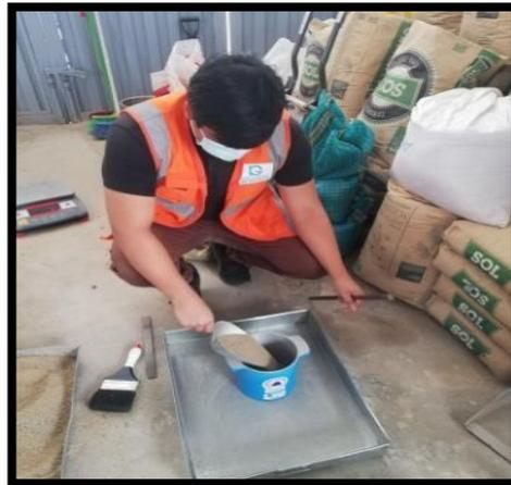
**Figura 4.** Enrasado de agregado fino
