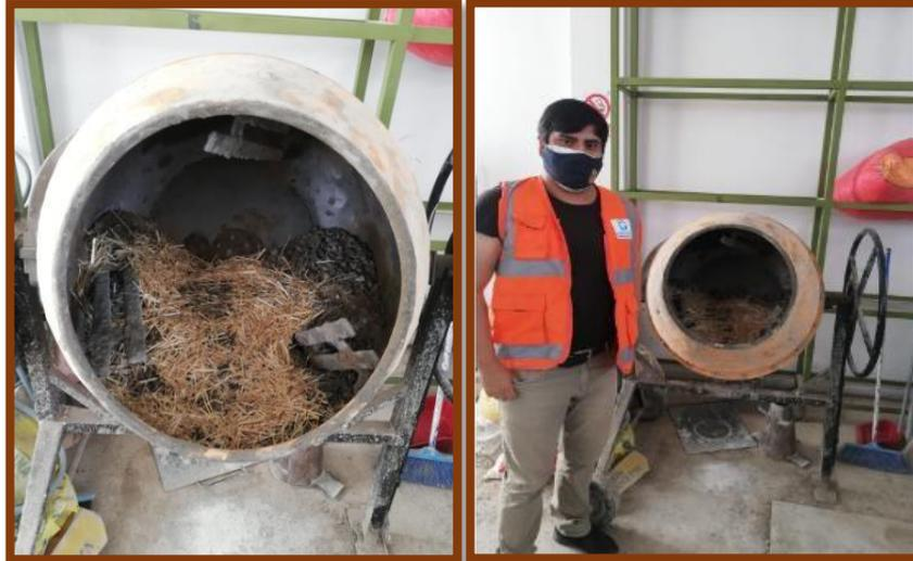
**Figura 9.** Diseño de mezcla con paja de trigo
