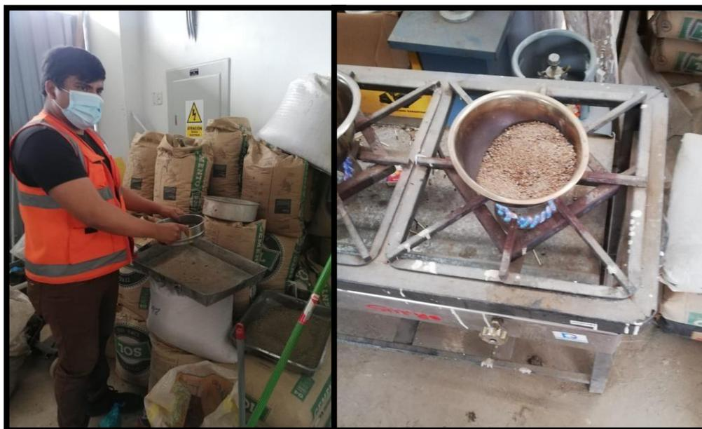
**Figura 5.** Ensayo de absorción de agregado fino
