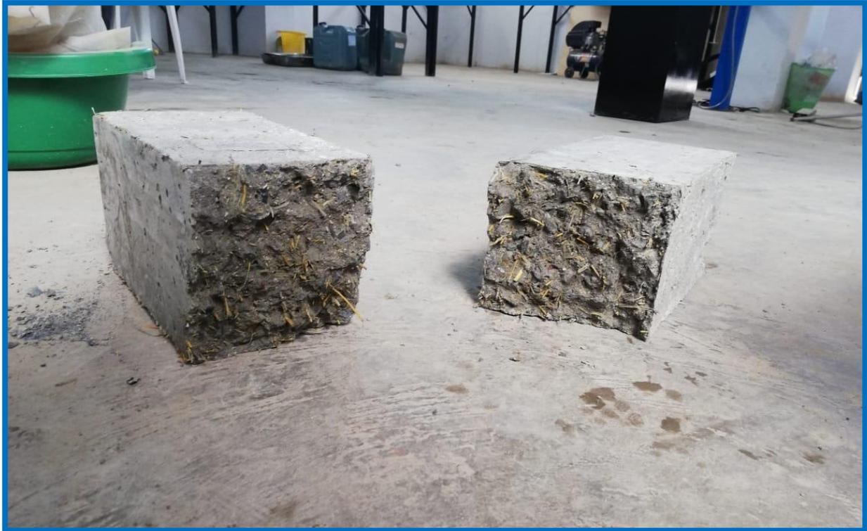
**Fotografía 13.** Ruptura del concreto prisma.
