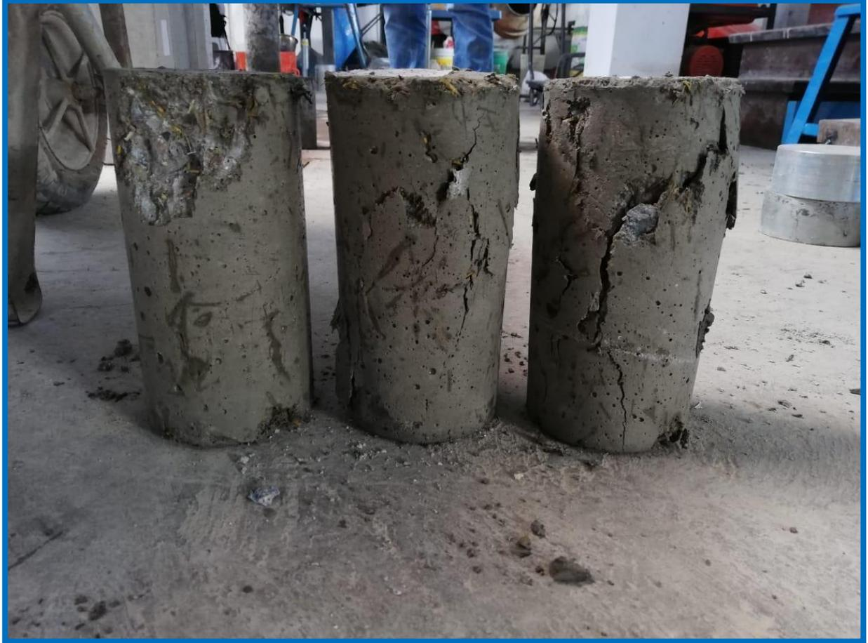
**Fotografía 15.** Tipos de rupturas.
