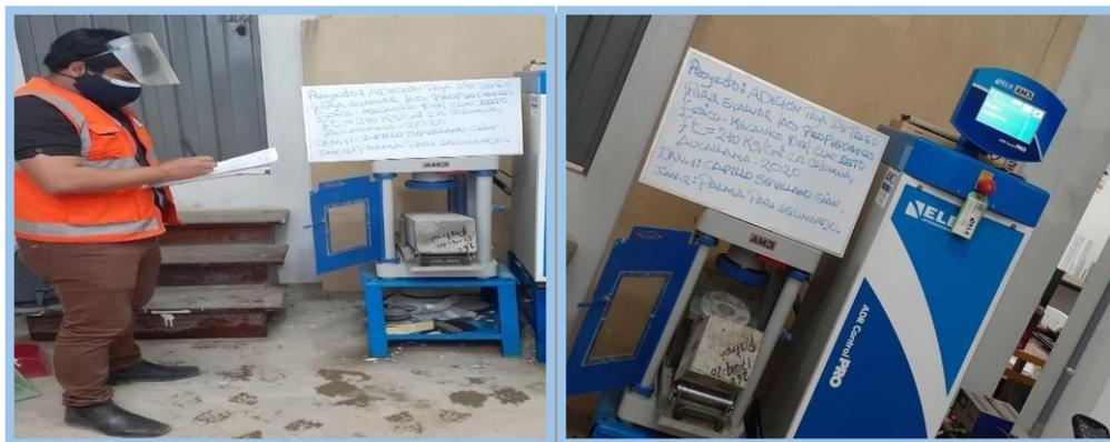
**Figura 21.** Ensayo de resistencia a la flexión
