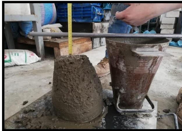
**Figura 15.** *Ensayo de Consistencia (Slump) con 0.5% de paja de trigo.*
