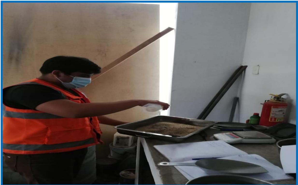
**Fotografía 4.** Caracterización de los agregados.
