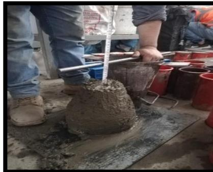
**Figura 17.** Ensayo de Consistencia (Slump) con 1.5% de paja de trigo
