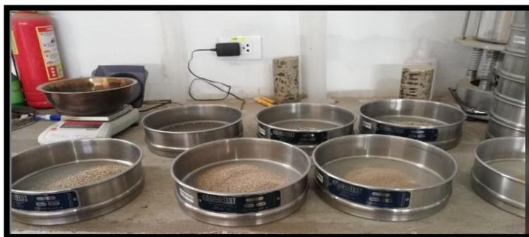
**Figura 3.** Granulometría agregado fino
