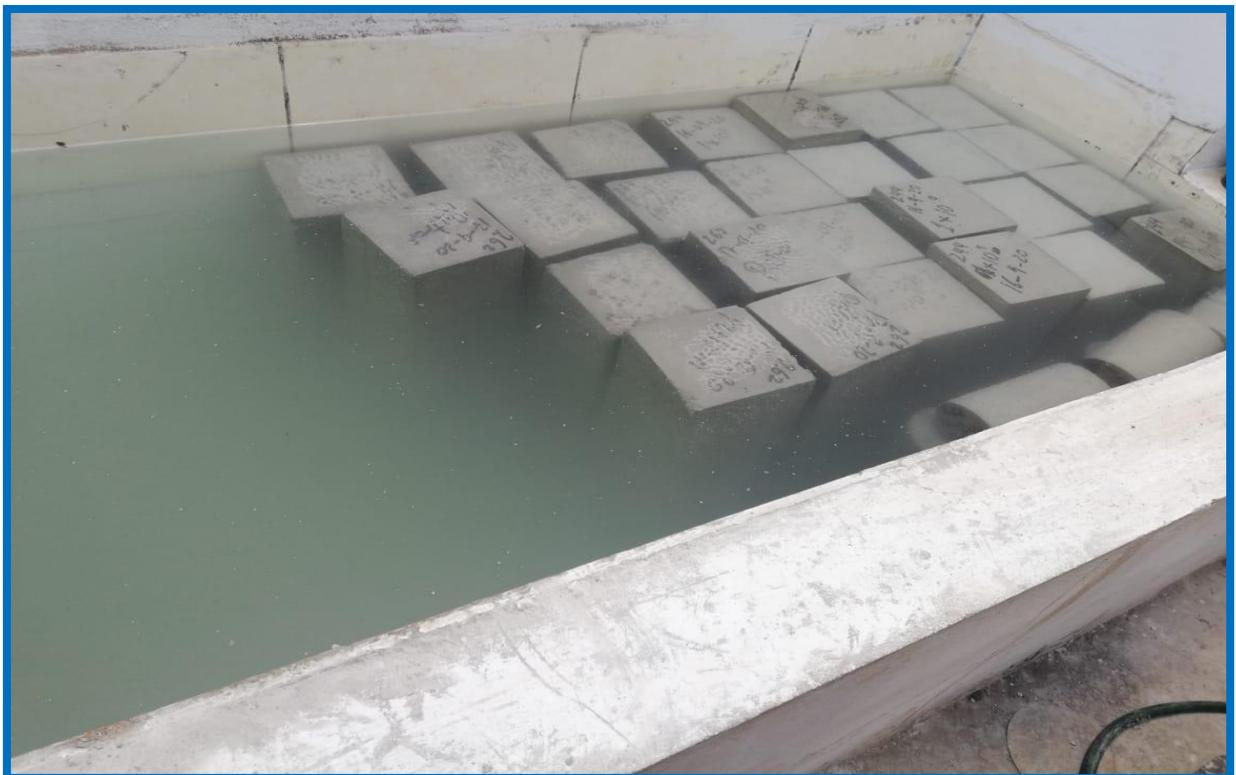
**Fotografía 10.** Curado del concreto prisma.
