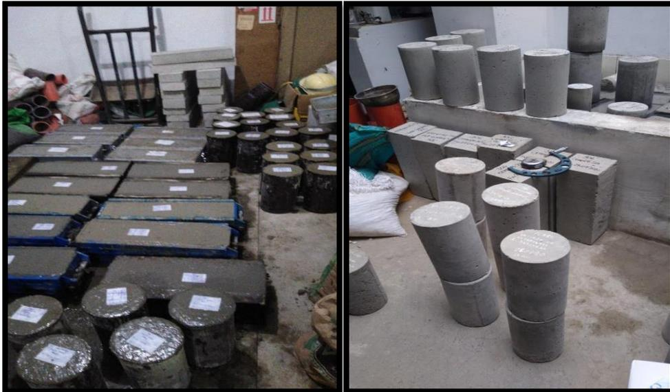
*Figura 19. Elaboración de probetas*
