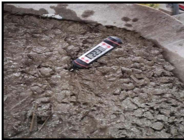
**Figura 11.** Ensayo de temperatura de diseño mezcla con 0.5 % de paja de trigo.
