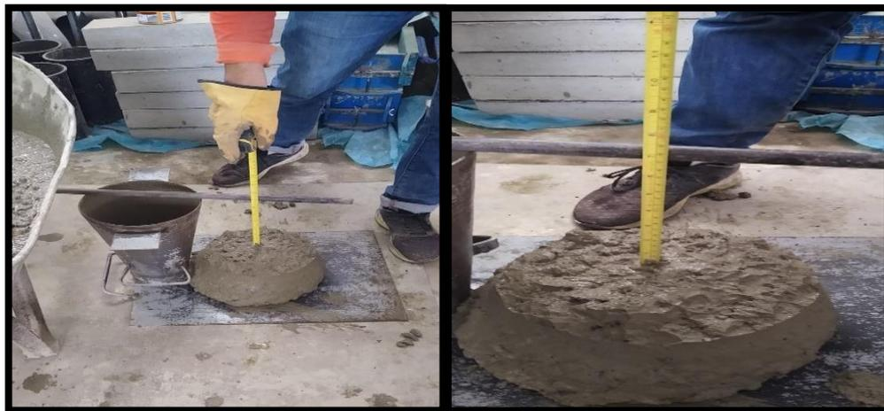
**Figura 14.** *Ensayo de Consistencia (Slump).*
