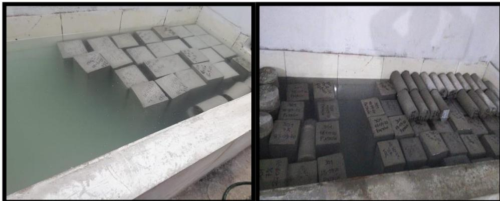
*Figura 20. Elaboración de curado de probetas*
