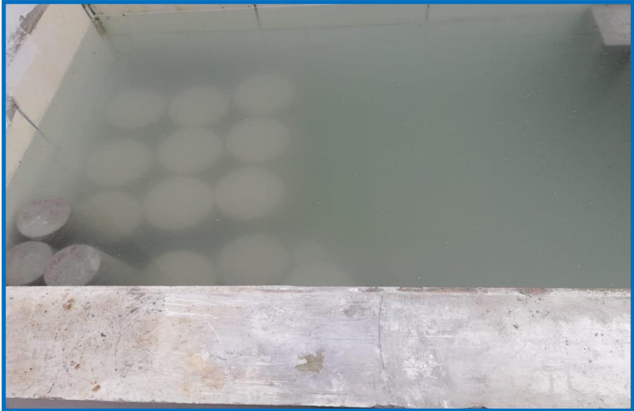
**Fotografía 11.** Curado Cilíndrica.
