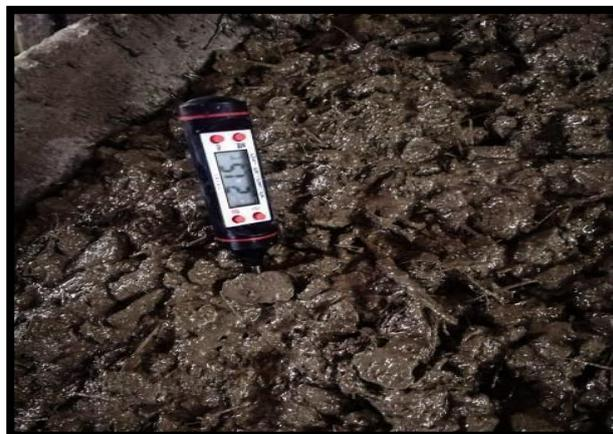
**Figura 13.** Ensayo de temperatura de diseño mezcla con 1.5 % de paja de trigo.
