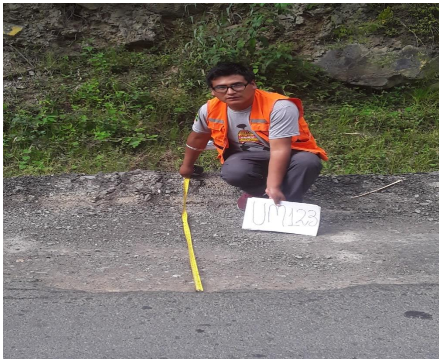
se ubica falla de tipo abultamiento en parches de severidad alta
