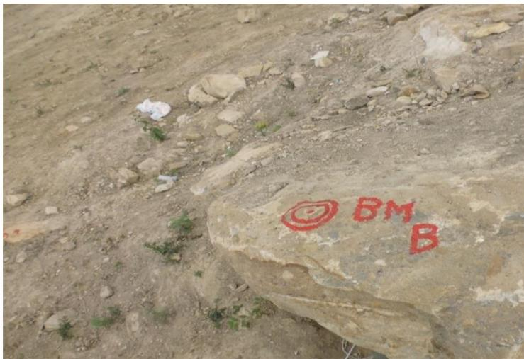
Fotografía 14. Vista del BMB. Se ubicó sobre una roca fija.
