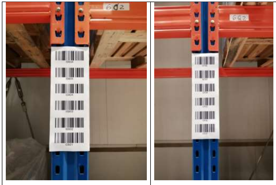
Figura 25: Tarjeta para identificación de andamios en almacén.
