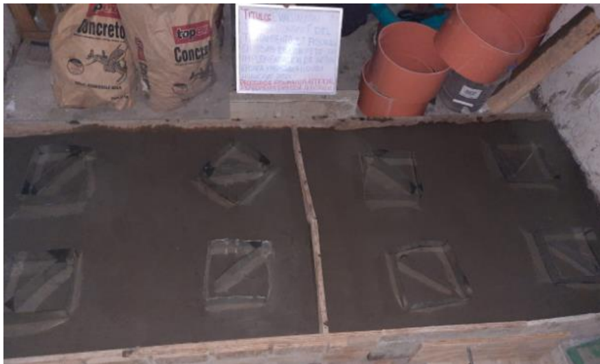
Figura N° 12 Fisuración artificial de especímenes tipo losa aligerada
