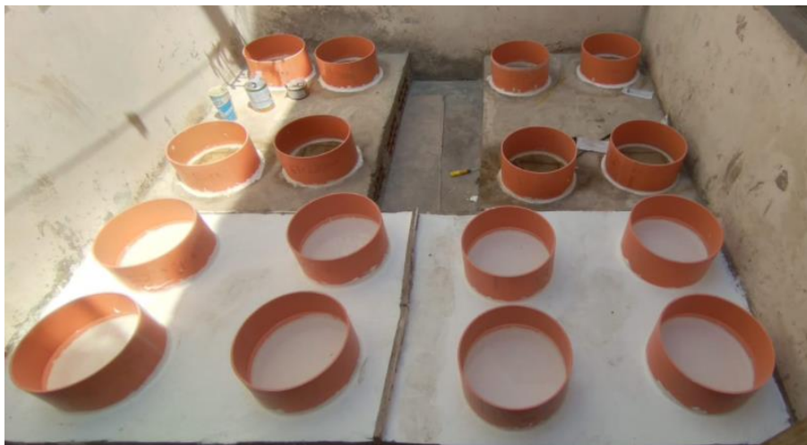
Figura N° 37 Ensayo de permeabilidad especímenes con tratamiento de membrana líquida (sikalastic 560) y resina epóxica (sikadur 52)
