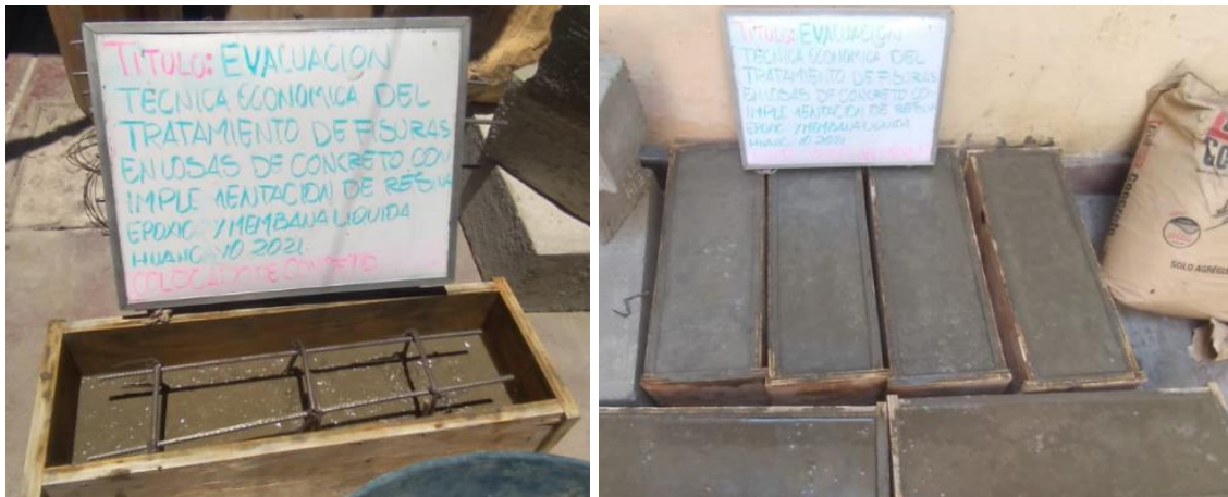
Figura N° 15 Colocado de concreto para los especímenes prismáticos
