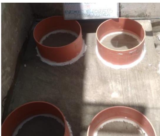
Figura N° 21 Ensayo de la permeabilidad especímenes no fisurados (especímenes patrón)
