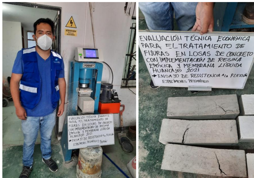
Figura Nº 35 ensayo resistencia a la flexión especímenes prismáticos patrón
