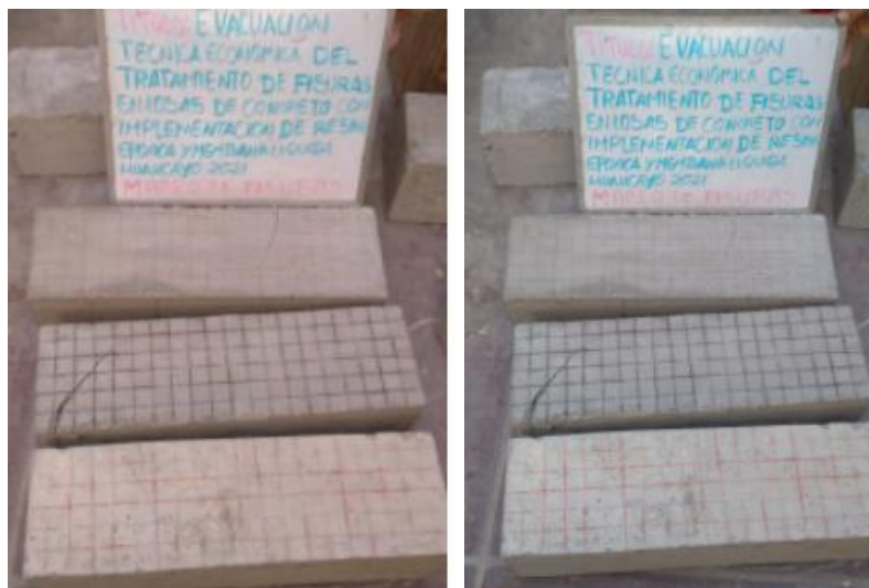
Figura N° 24 Mapeo de fisuras
