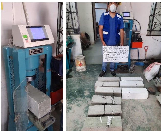
Figura N° 36 ensayo resistencia la flexión especímenes prismáticos fisurados con tratamiento de membrana líquida (Sikalastic 560) y resina epóxica (Sikadur 52)
