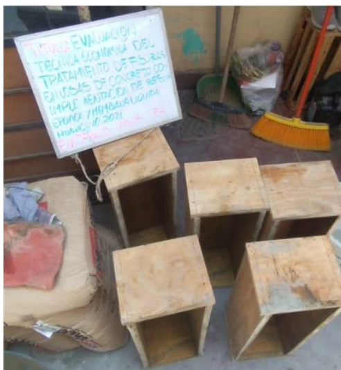
Figura N° 14 Encofrado para los especímenes prismáticos
