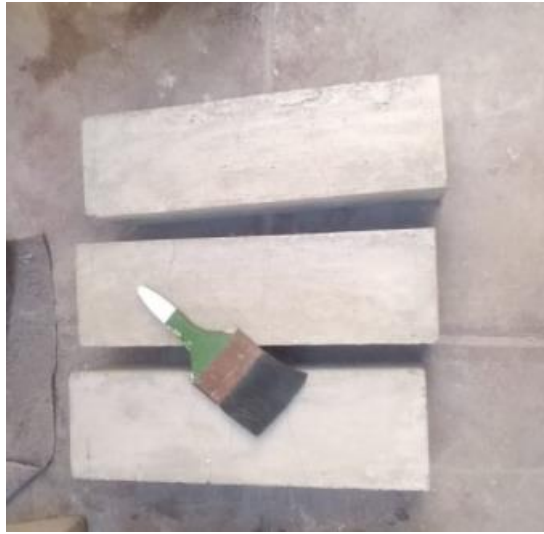
Figura N° 26 Preparación de la superficie
