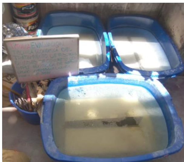
Figura N° 18 Curado de especímenes prismáticos de concreto
