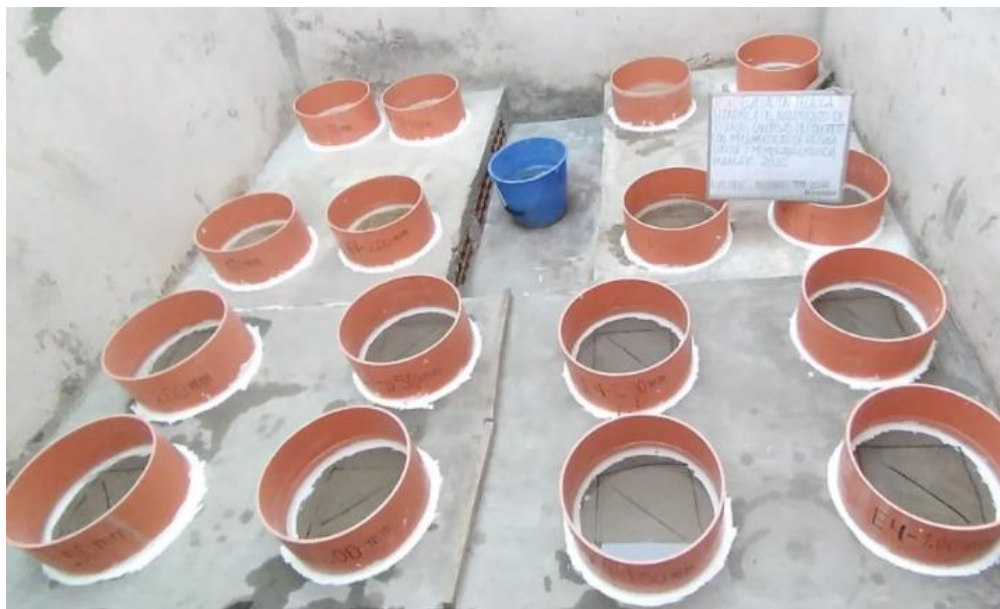
Figura N° 22 Inicio ensayo de permeabilidad especímenes fisurados
