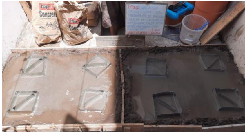
Figura N° 17 Curado de especímenes tipo losa aligerada con fisuración artificial
