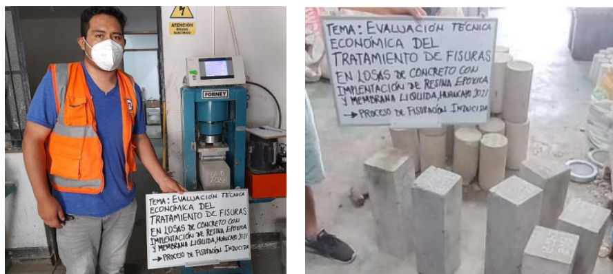
Figura N° 19 Proceso de fisuración especímenes prismáticos
