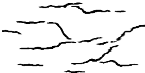
Figura N° 2 Agrietamiento típico por contracción plástica
