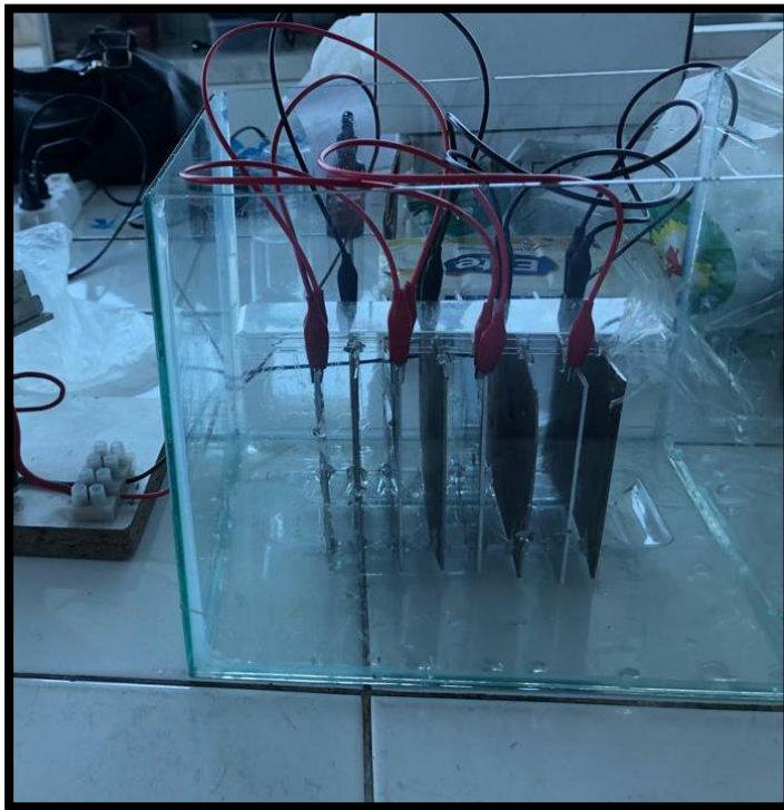
Figura 13. Equipo de electrocoagulación ya terminado.
