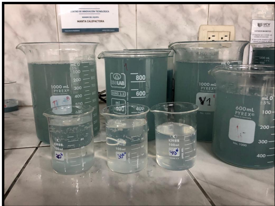
Figura 18. Recolección de muestra para evaluar parámetros de Turbidez.
