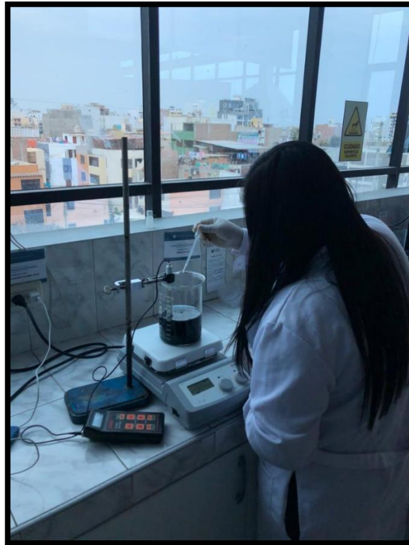
Figura 9. Aplicación del NaOH, para aumentar el pH y sedimente el Cr.
