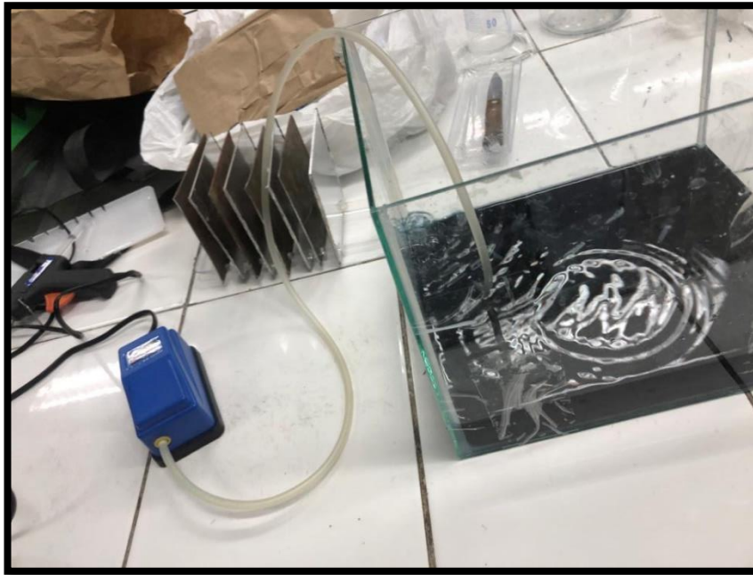
Figura 7. Aireación de la muestra para su previo tratamiento.
