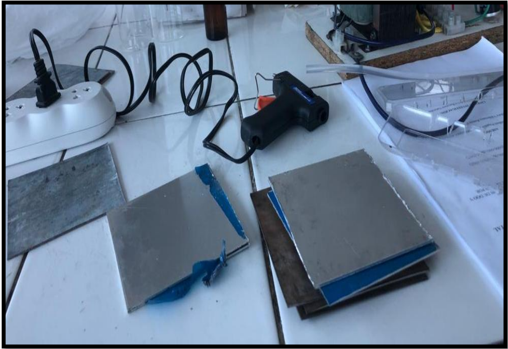
Figura 11. Placas de electrocoagulación (electrodos de aluminio y fierro)
