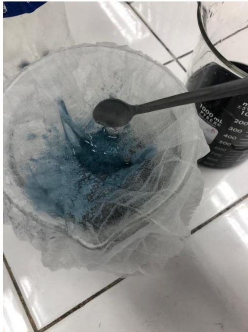
Figura 6. Tamizado de la muestra para su previa aireación
