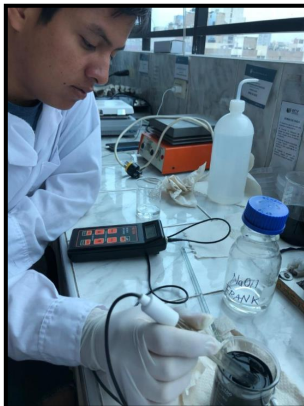
Figura 10. Medición de pH, obteniendo un Ph mayor a 9.
