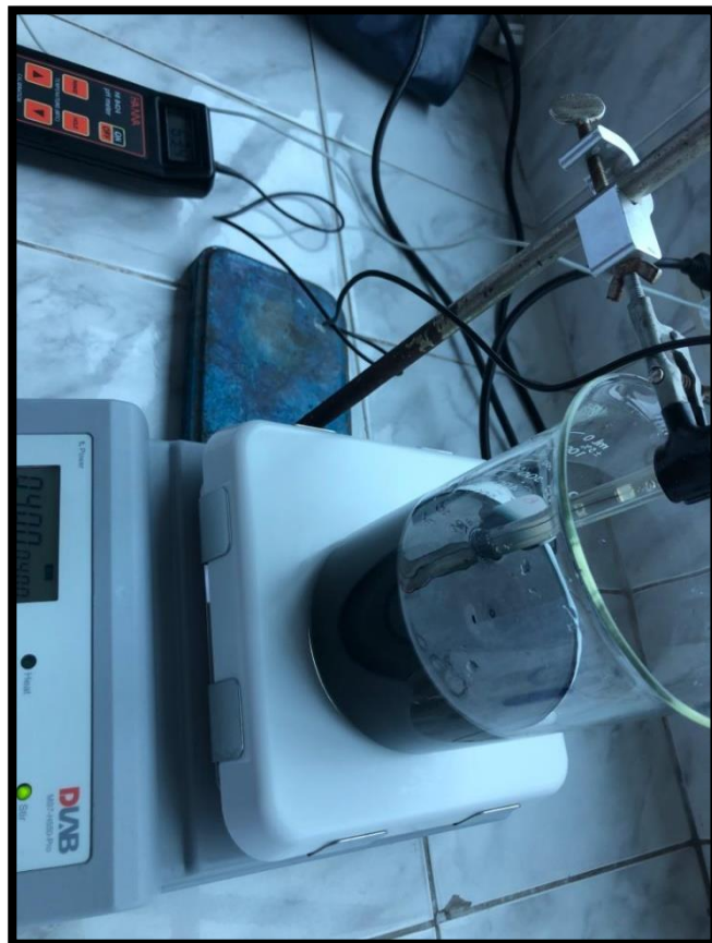
Figura 8. Agitación de la muestra, antes de aplicarle el NaOH para el pre tratamiento.
