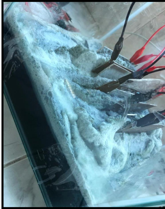
Figura 15. Proceso de electrocoagulación con 06 placas
