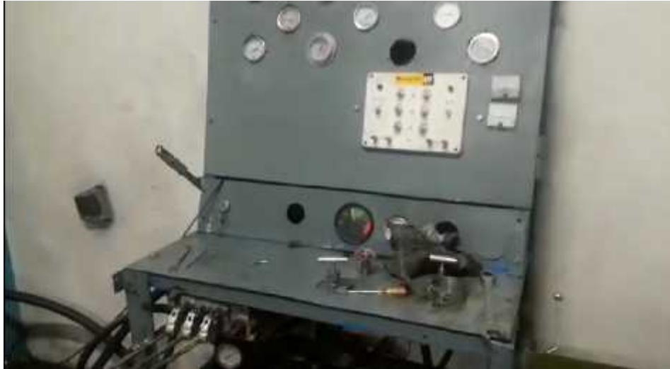
Figura 1. Banco de pruebas artesanal de bombas oleo hidráulicas
