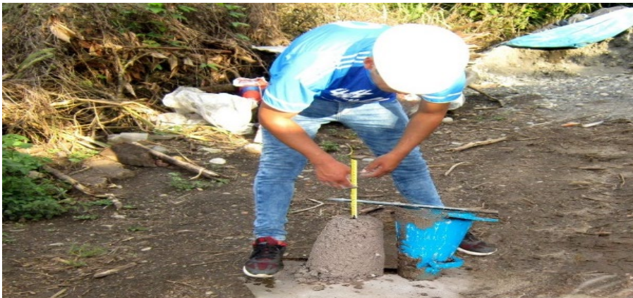
Figura 19 ensayo de slump medición de asentamiento.
