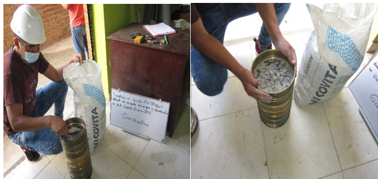
Figura 13 tamizaje de los agregados
