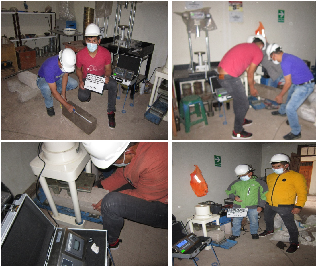
Figura 26 Rotura de vigas Fuente: Propia
