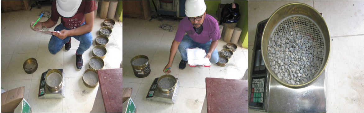
Figura 14 clasificación y pesado de agregados retenidos en los tamices Fuente: Propia
