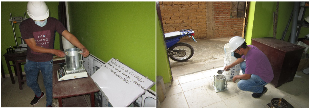
Figura 15 pesado del recipiente y colocado de agregado Fuente: Propia
