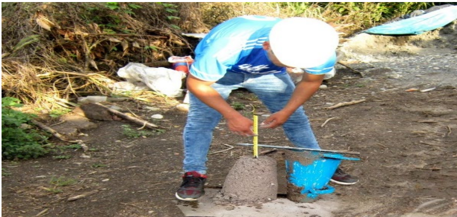
Figura 19 ensayo de slump medición de asentamiento.
