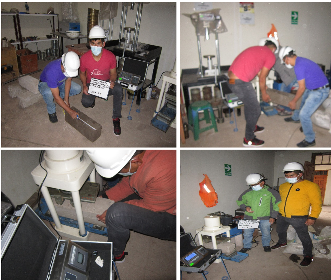
Figura 26 Rotura de vigas
