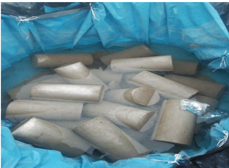
Figura 24 Curado de concreto Fuente: Propia
