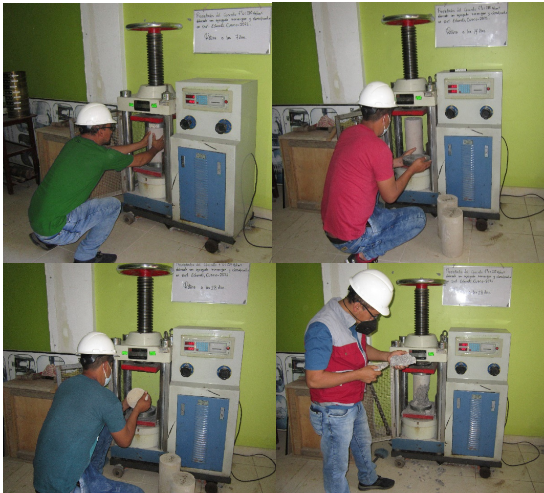
Figura 25 Rotura de briquetas Fuente: Propia
