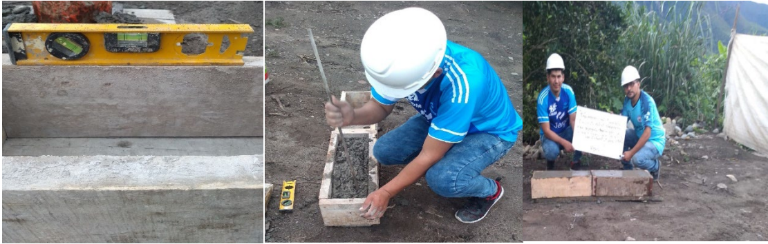
Figura 23 Elaborando probetas Prismáticas (vigas). Fuente: propia.
