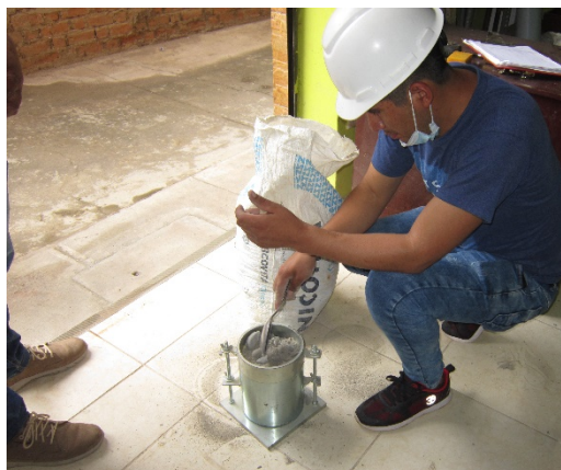
Figura 21 colocado de concreto al recipiente
