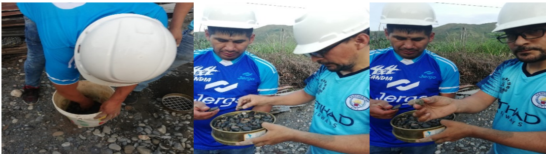
Figura 18 Tamizado de agregado IN SITU. Fuente: propia.
