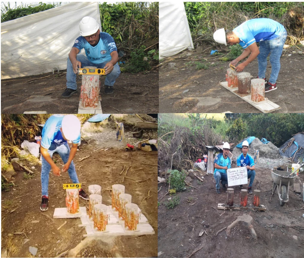
Figura 22 Elaborando probetas circulares. Fuente: propia.
