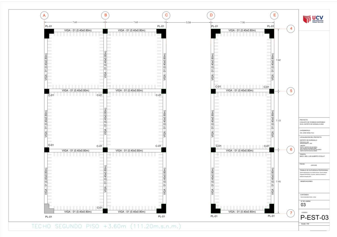
Figura 60. Plano estructural techo segundo piso.
