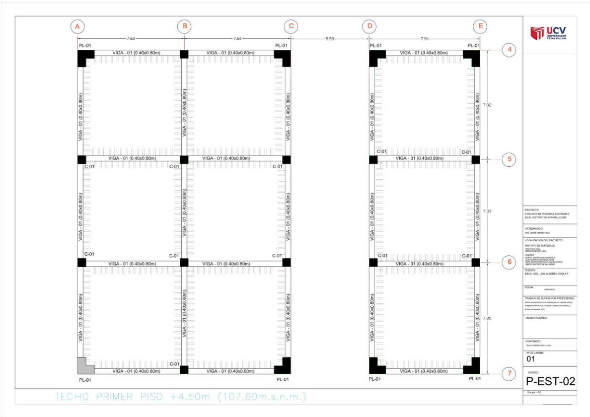
Figura 59. Plano estructural techo primer piso.
