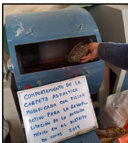
Figura 11. Ensayo de los Ángeles.
