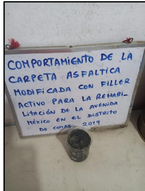
Ensayo de Sales Solubles en Agregados para pavimento Flexible MTC E 219
