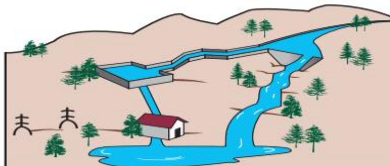
Figura 2: Central hidroeléctrica de tipo fluyente
