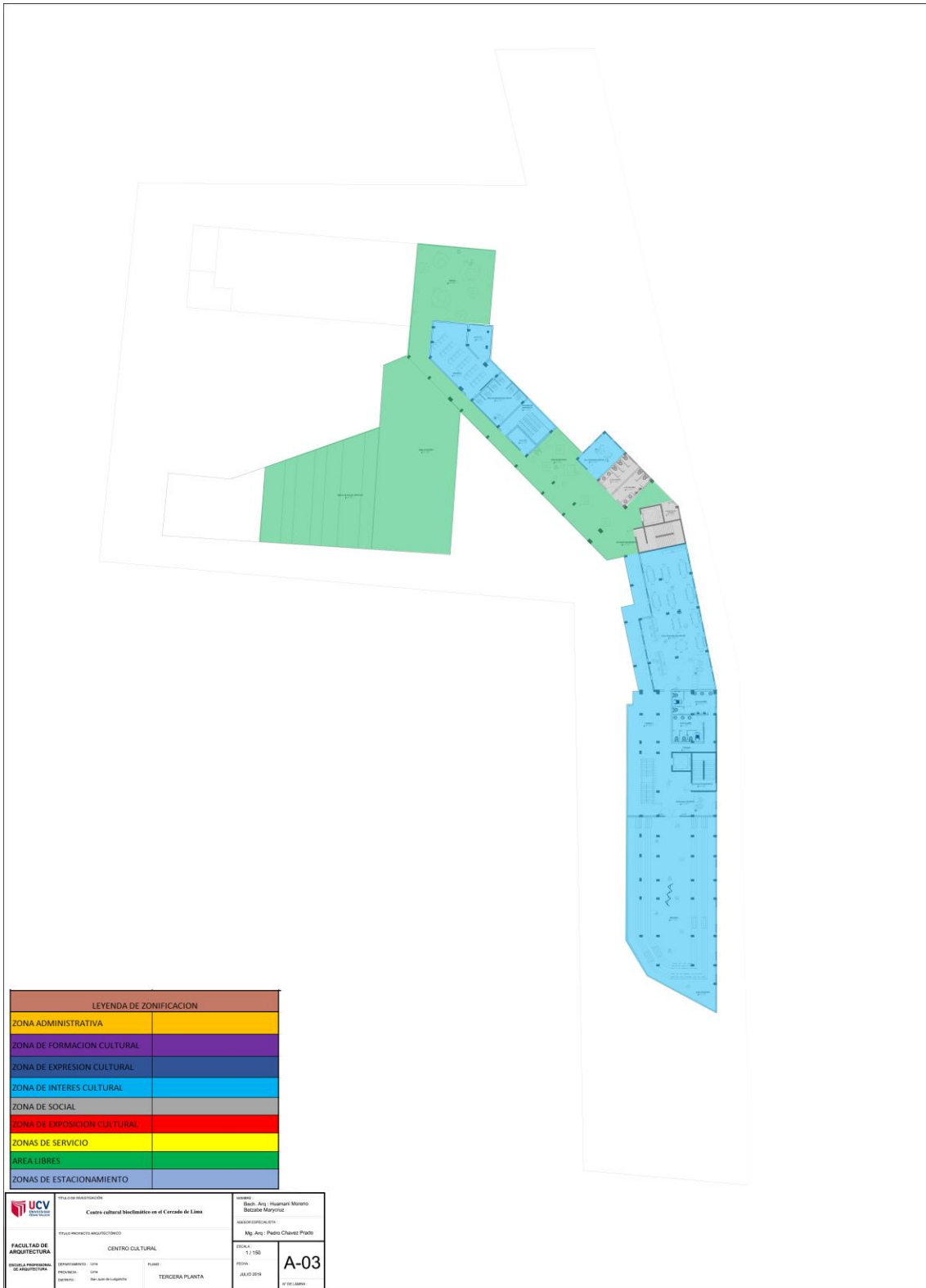
Figura 162: Zonificación del tercer nivel. Elaboración propia
