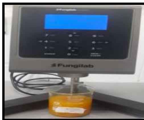
Ilustración 03: Muestra sometida al análisis reológicos utilizando el viscosímetro FUNGILB
