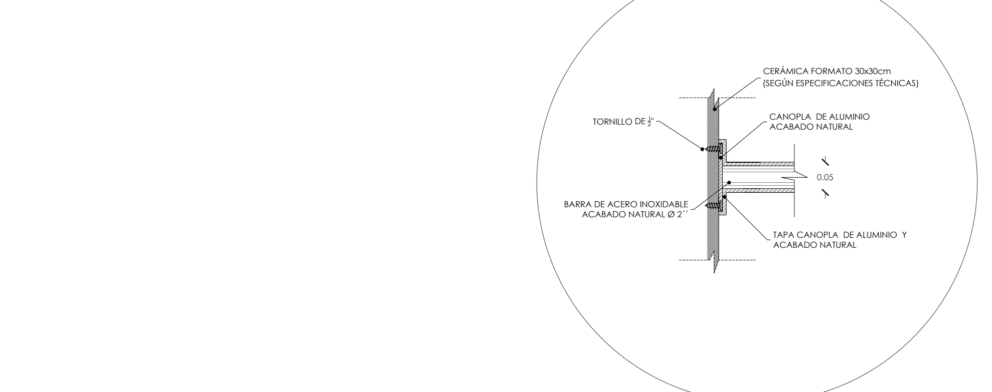
DET. FIJACIÓN DE BARRA DE DISCAPACITADOS EN PISO ESC: 1/5
