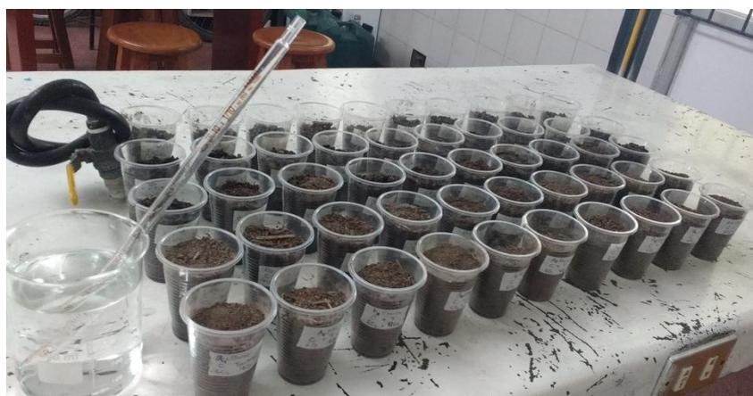
**Figura 10.** Ensayos preliminares de la retención de agua
