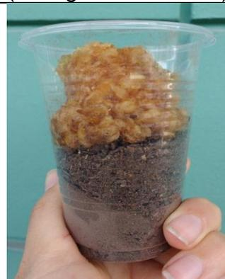
**Fotografía 22.** Mezcla del hidrogel estabilizado con la tierra preparada seca
