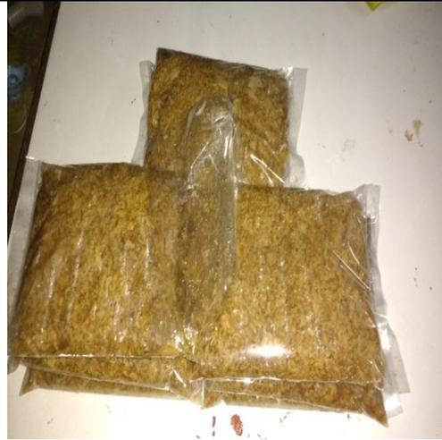
**Fotografía 20.** Recuperación de la celulosa y poliacrilato de sodio del pañal (hidrogel estabilizado)
