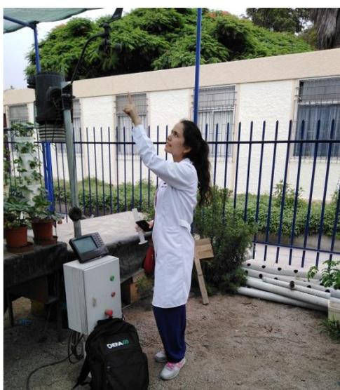
**Figura 11.** Estación Meteorológica (Davis vantage Pro2) del Centro de Investigación de Hidroponía y Nutrición Mineral
