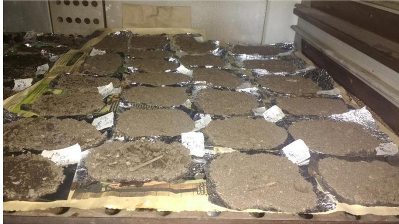
**Figura 12.** Muestras de la mezcla de hidrogel y tierra preparada en la estufa
