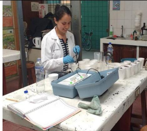
**Fotografía 26.** Medición de los parámetros fisicoquímicos de la mezcla del hidrogel y la tierra preparada
