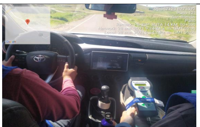
Figura 12 Identificando irregularidades en la carretera
