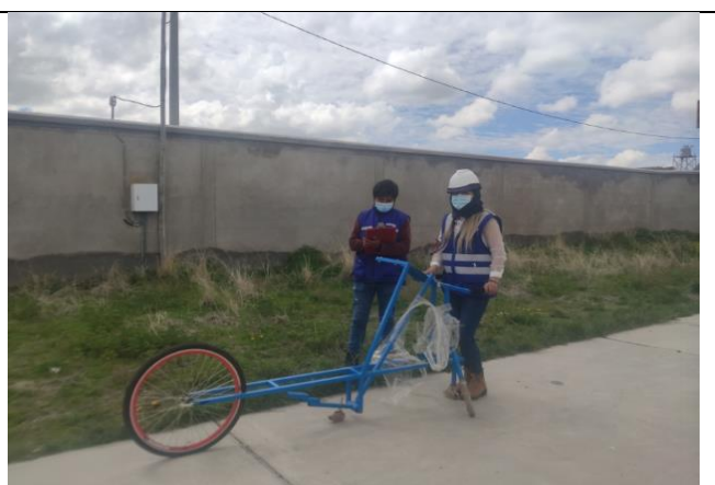
Figura 14 Inicio de calibración de Equipos Toma de Datos con el Rugosímetro de Merlín
