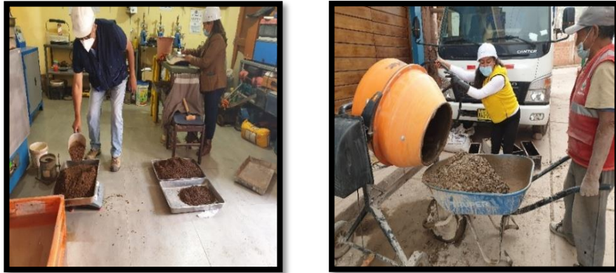
Figura 36. Pesado de Agregados Gruesos y Finos, Mezclado del Concreto
