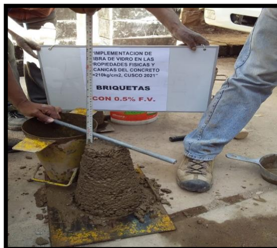
Figura 41. Medición del Slump en Concreto Fresco
