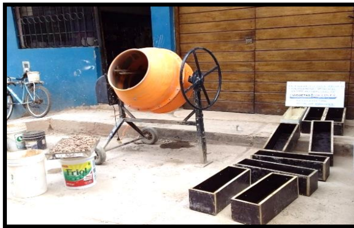
Figura 34. Molde Prismáticas de Madera
