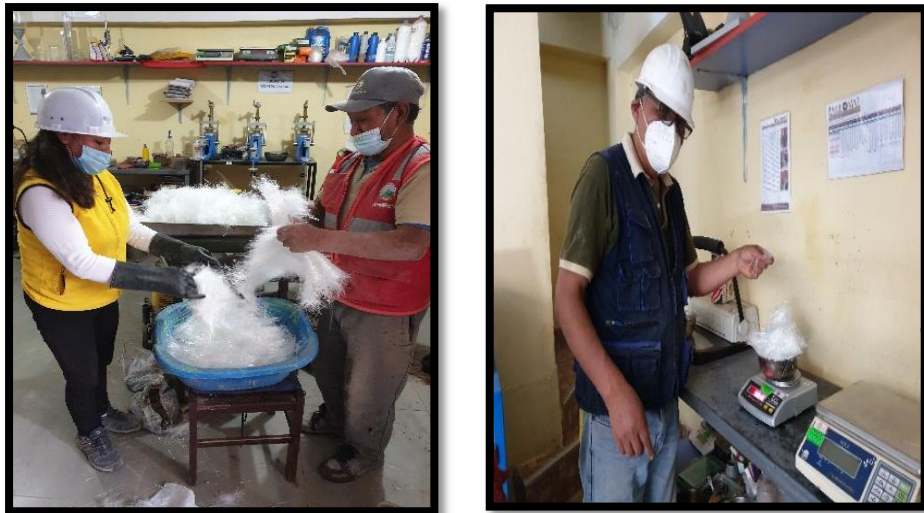
Figura 35. Preparación y Pesado de las Fibras de Vidrio
