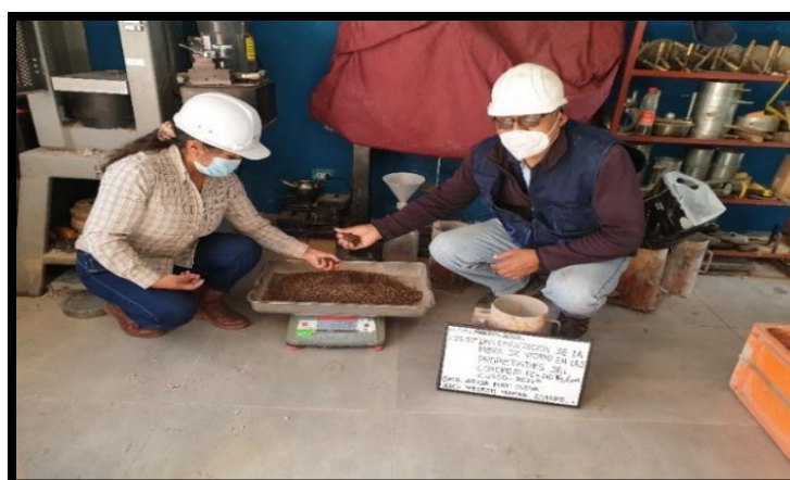
Figura 24. Pesado del Agregado Grueso en la Balanza a Precisión
