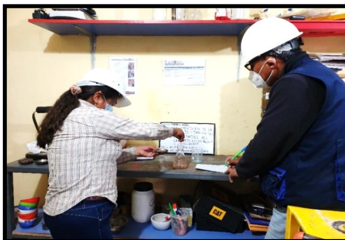
Figura 31. Colocado del Agregado Fino, Secado en la Fiola
