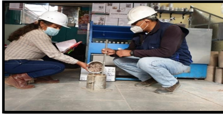
Figura 32. Varillado del Agregado Grueso y Fino en el Molde
