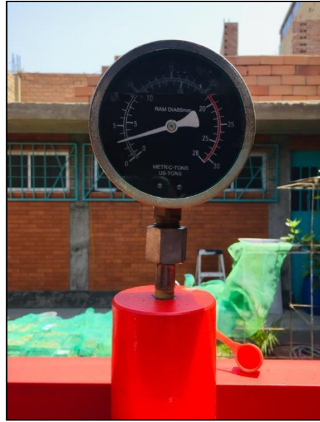
Imagen 53. Compactación de la maquina briquetadora con una fuerza de 3000 kg
