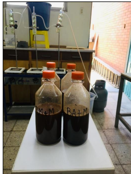
Imagen 39. Mezcla de las biomazas más aglutinante para la realización de la RPM
