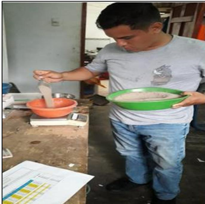
**Descripción:** Se aprecia el pesado de los agregados. (piedra chancada, arena triturada y arena natural) para realizar los ensayos de la mezcla asfáltica convencional.
