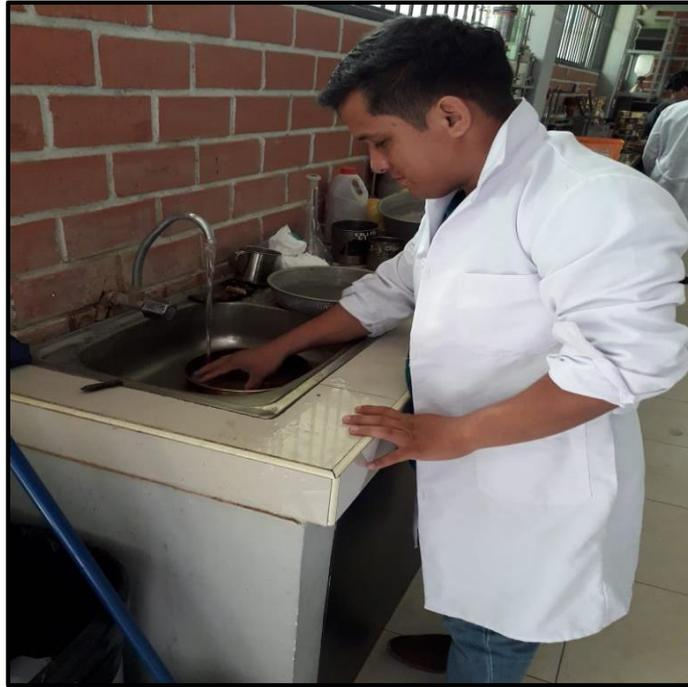
**Descripción:** Se aprecia el lavado de las muestras usando la malla #200, para luego realizar los ensayos de granulometría.
