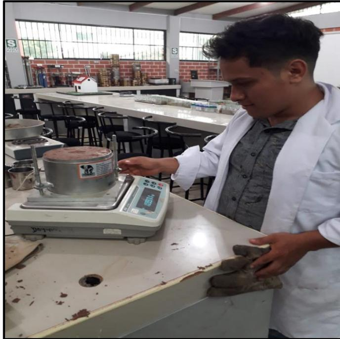
**Descripción:** Se observa el pesado del (molde + muestra) en los ensayos de Proctor modificado.
