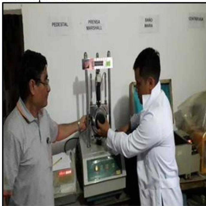
**Descripción:** se aprecia la colocación de las briquetas, en la prensa Marshall, la cual determino la fluidez y la estabilidad de cada tentativa.
