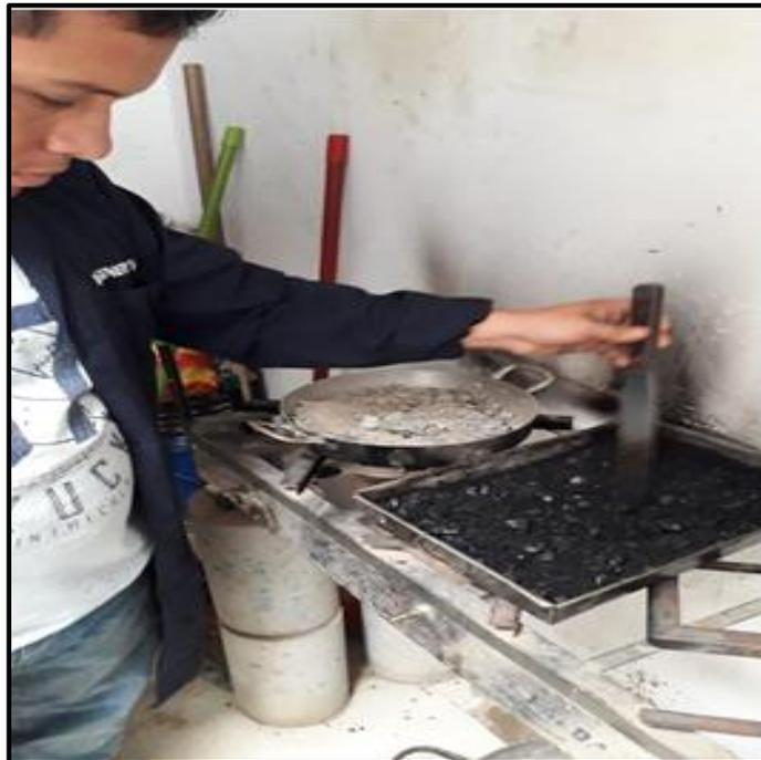
**Descripción:** se observa el mezclado de los materiales, hasta llegar a una mezcla homogénea de todos los materiales usados para el diseño del pavimento convencional.
