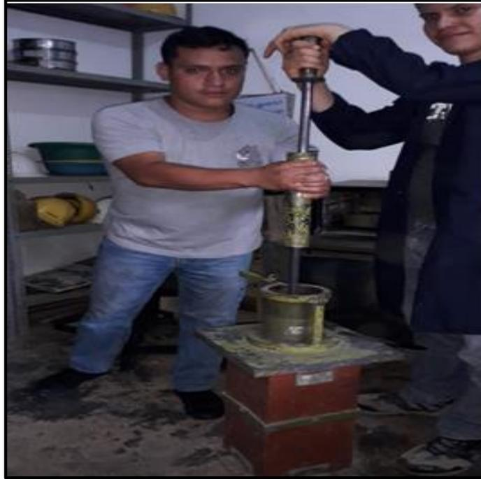
**Descripción:** se observa el molde de compactación Marshall, para la elaboración de briquetas el ensayo también denominado caras fracturadas.
