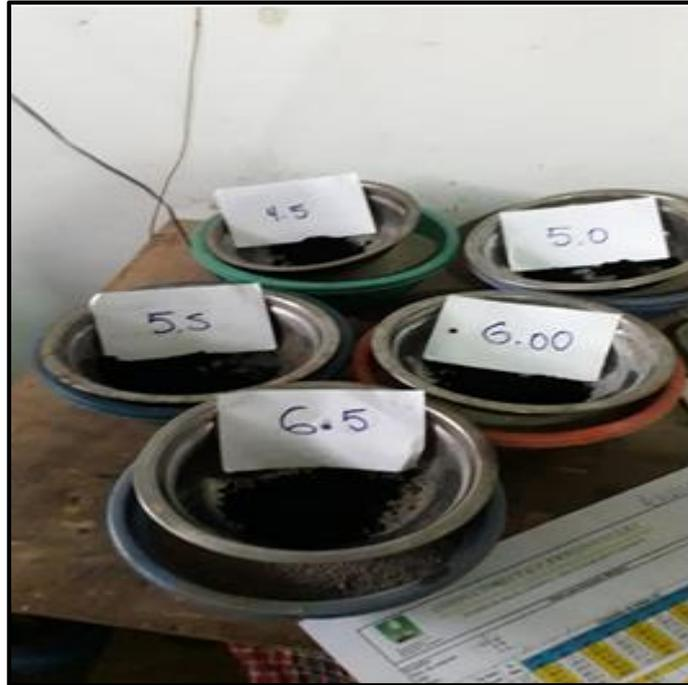
**Descripción:** Se observa las tentativas de 4.50, 5.00, 5.50, 6.00 y 6.50 que ser realizo para los ensayos de la mezcla asfáltica modificada usando polvo de neumático.
