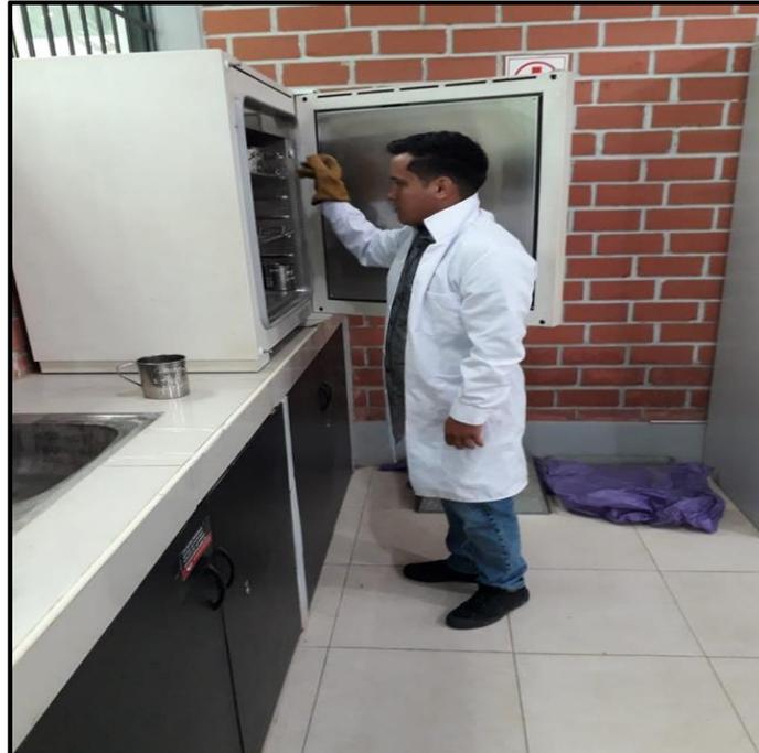
**Descripción:** Se aprecia la colocación de las muestras en el horno para determinar el porcentaje de humedad de cada muestra.
