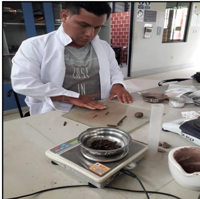
**Descripción:** Se observa los ensayos de limite plásticos y el pesado de los mismos para poder determinar el contenido de humedad.
