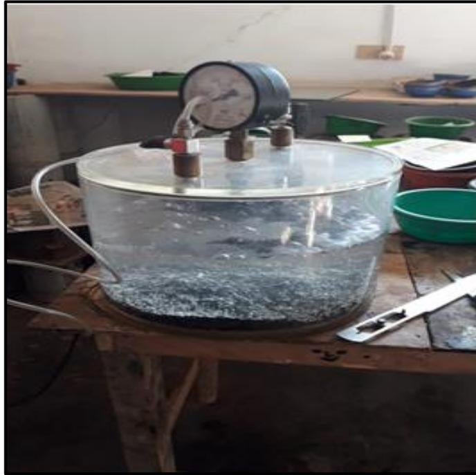
**Descripción:** se aprecia la ejecución de los ensayos de RICE, para la determinación de los vacíos en la mezcla asfáltica.
