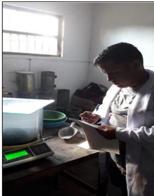
**Descripción:** se aprecia los apuntes de pesos en los ensayos de RICE, para la determinación de los vacíos en la mezcla asfáltica.
