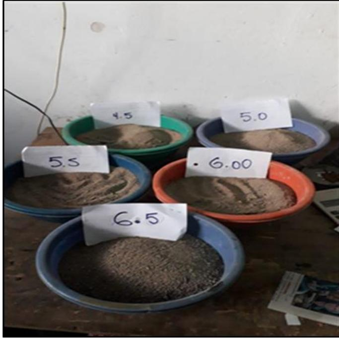
**Descripción:** Se observa las tentativas de 4.50, 5.00, 5.50, 6.00 y 6.50 que ser realizo para los ensayos de la mezcla asfáltica convencional.
