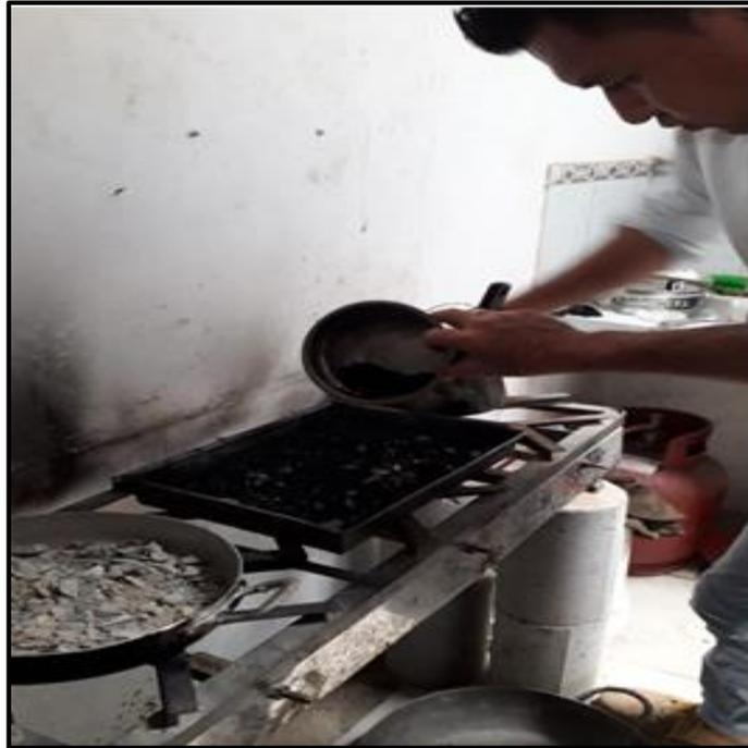
**Descripción:** se observa la colocación del aditivo (polvo de neumático) para el diseño del pavimento modificado.
