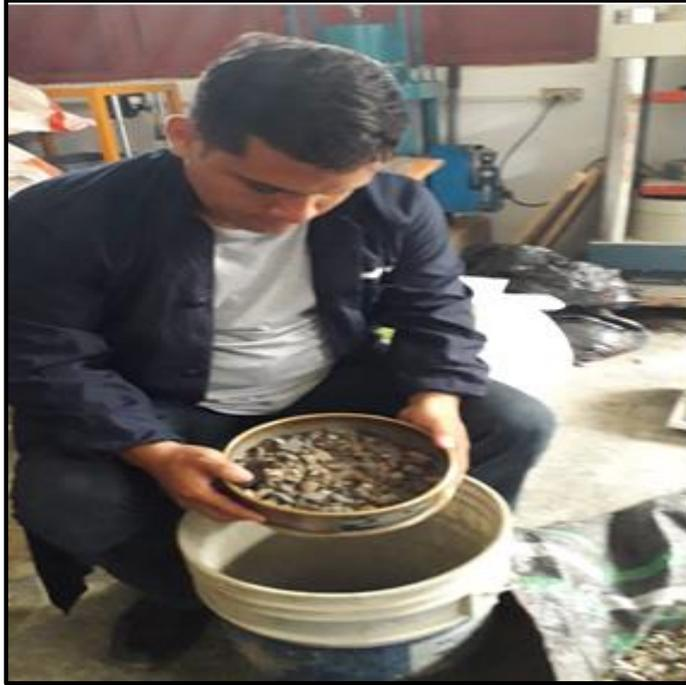
**Descripción:** Se observa el tamizado de los agregados para ser usados en la mezcla asfáltica convencional y la mezcla asfáltica modificada usando polvo de neumático.
