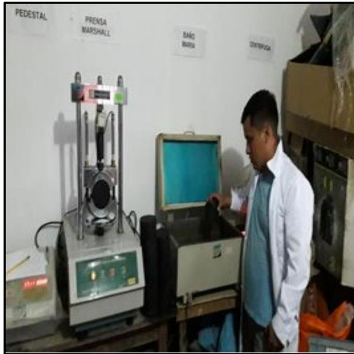
**Descripción:** Se realizó el baño de maría que se utiliza para incubar muestras en agua a una temperatura constante para los diferentes tentativas.
