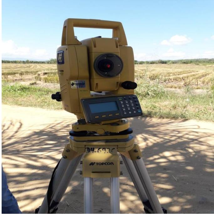
**Descripción:** Se observa el equipo (ESTACION TOTAL) para la cual se utilizó para realizar todo el levantamiento topográfico del tramo Caserío San José – CP. Carhuapoma.
