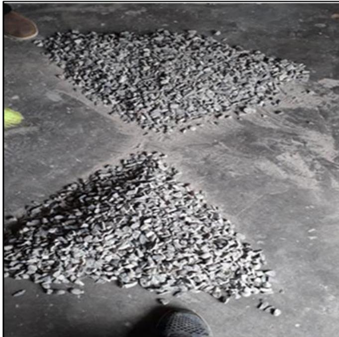
**Descripción:** Se aprecia el cuarteo de los agregados para tener una mezcla homogénea y realizar los ensayos de granulometría de los agregados.
