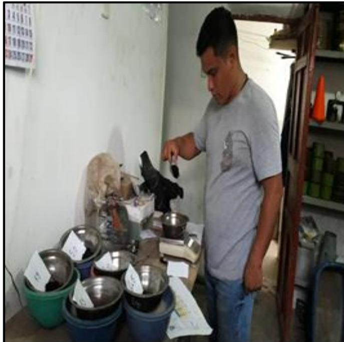
**Descripción:** Se aprecia el pesado de los agregados. (piedra chancada, arena triturada, arena natural y polvo de neumático) para realizar los ensayos de la mezcla asfáltica modificada.
