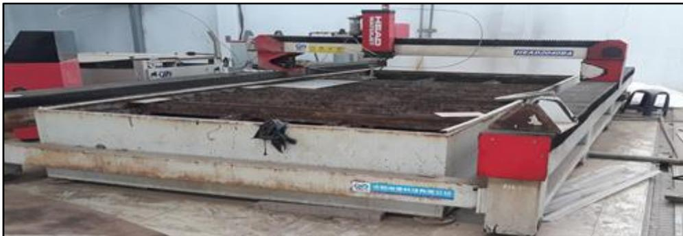
*Figura 11: Máquina de corte por chorro de agua del área de corte*
