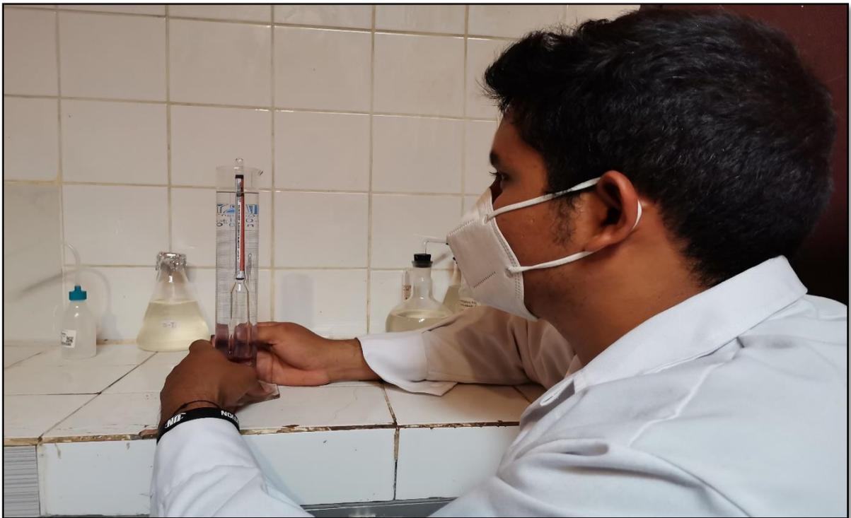
**Verificación del etanol obtenido tras el proceso de fermentación.**
