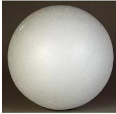
Figura 1. Flotador para calcular el caudal
