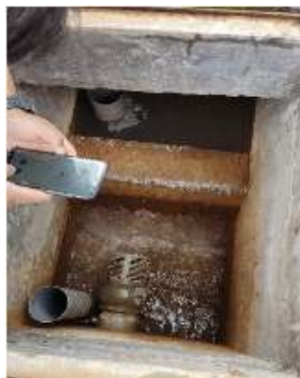
Foto N° 16: Aforo en la Cámara de Carga por el Método Volumétrico
