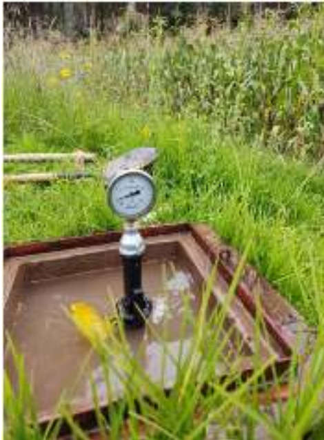
Foto N° 8: Presión del aspersor utilizando un Manómetro
