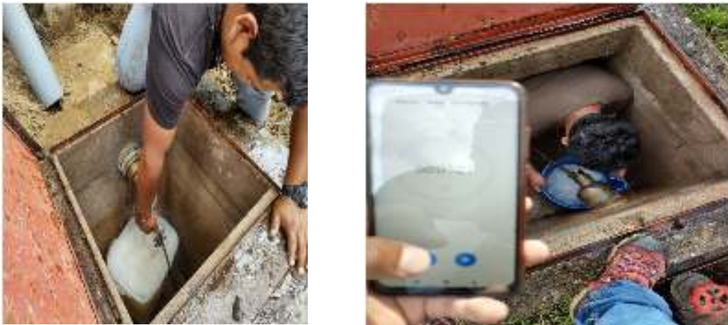
Foto N° 6: Aforo en la Cámara Rompe Presión
