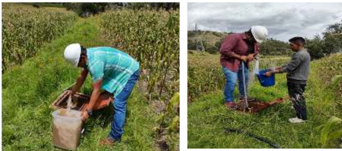
Foto N° 7: Aforo de Hidrantes en la Línea de Distribución
