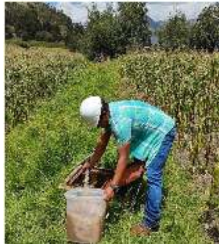
Foto N° 19: Medición de la Presión Estática en los Hidrantes
