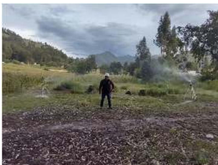
Foto N° 22: Prueba de Aspersores en el Ultimo Hidrante
