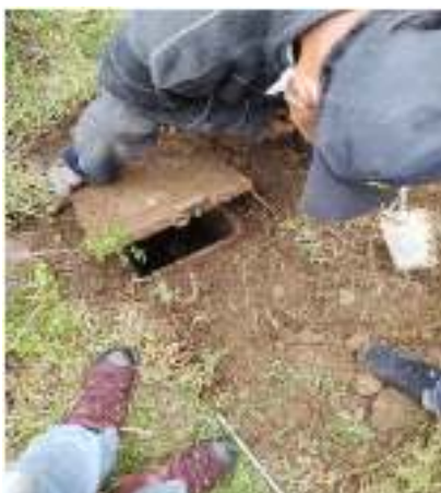
Foto N° 16: Aforo en la Cámara de Carga por el Método Volumétrico
