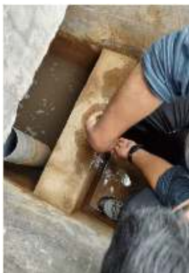
Foto N° 16: Aforo en la Cámara de Carga por el Método Volumétrico
