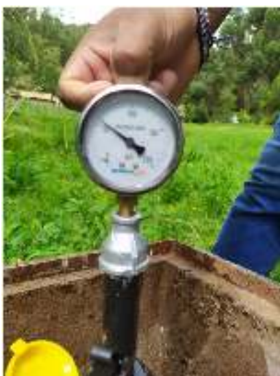
Foto N° 19: Medición de la Presión Estática en los Hidrantes
