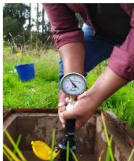
Foto N° 19: Medición de la Presión Estática en los Hidrantes
