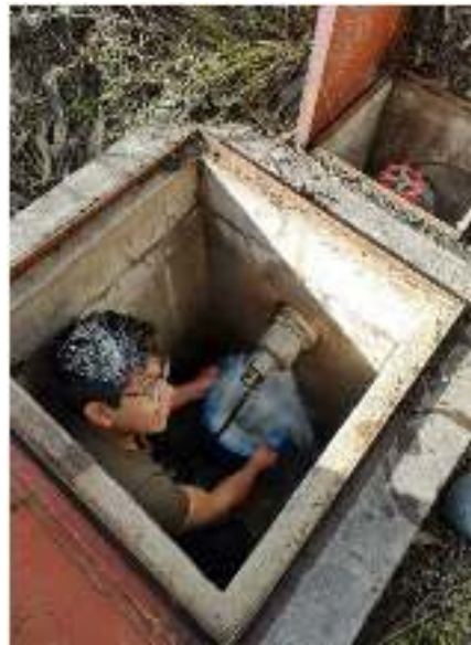
Foto N° 18: Aforo en la Cámara Rompe Presión en la Linea de Conduccion
