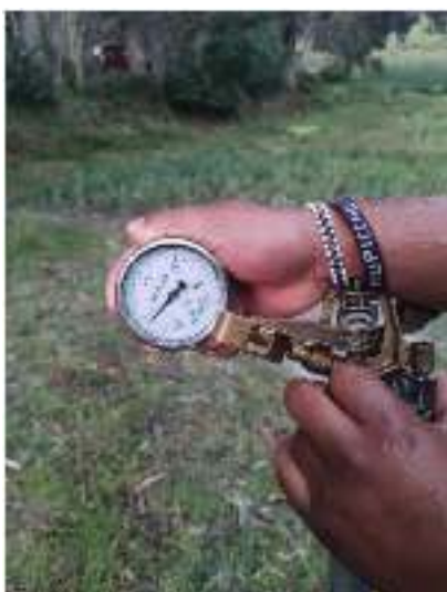
Foto N° 22: Prueba de Aspersores en el Ultimo Hidrante
