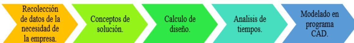
Figura 7: Diagrama de flujo con los pasos generales del diseño.
