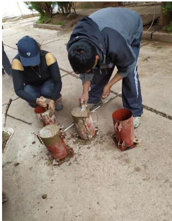
Figura N° 15: Colocación del concreto en probetas cilíndricas Fuente: Elaboración propia
