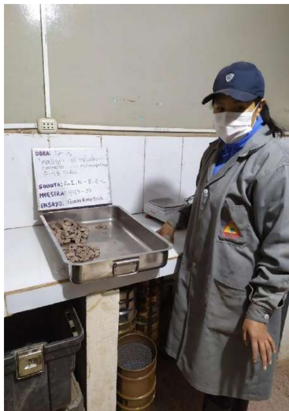
Figura N° 09: Tamizado de los agregados Fuente: Elaboración propia
