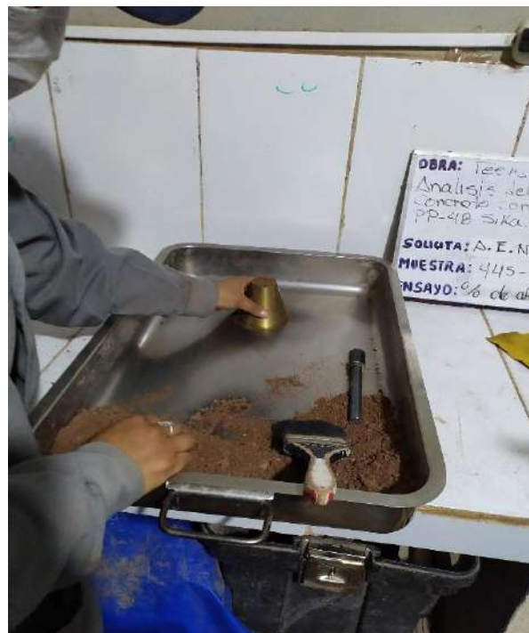
Figura N° 02: Ensayo de prueba de absorción Fuente: Elaboración propia
