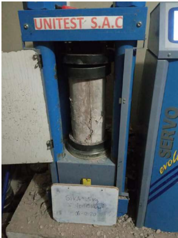
Figura N°27, 28, 29 y 30: Rotura de especímenes de concreto Fuente: Elaboración propia
