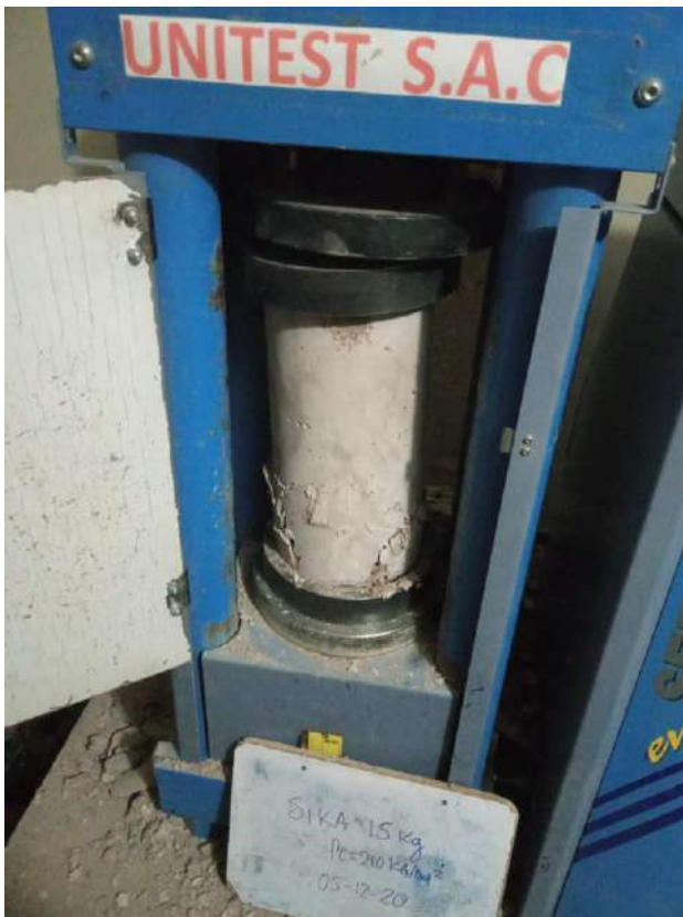
Figura N°23, 24, 25 y 26: Rotura de especímenes de concreto Fuente: Elaboración propia
