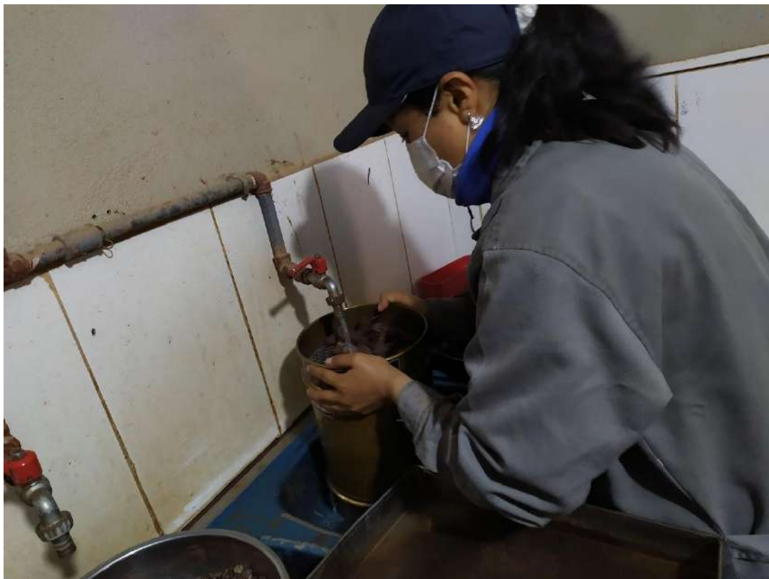
Figura N° 07: Lavado de los agregados Fuente: Elaboración propia
