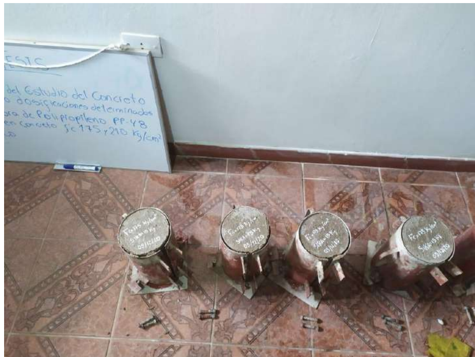
Figura N° 20: Rotulado de los especímenes de concreto Fuente: Elaboración propia
