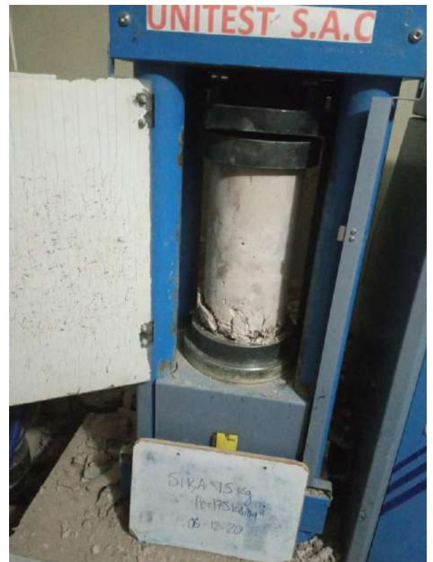
Figura N°27, 28, 29 y 30: Rotura de especímenes de concreto Fuente: Elaboración propia
