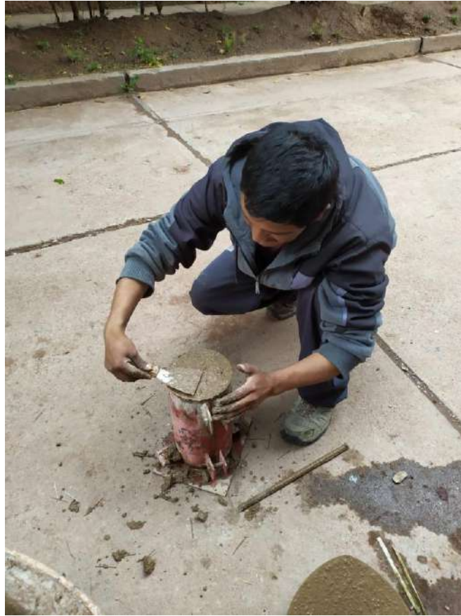
Figura N° 19: Enrasado de los especímenes de concreto Fuente: Elaboración propia
