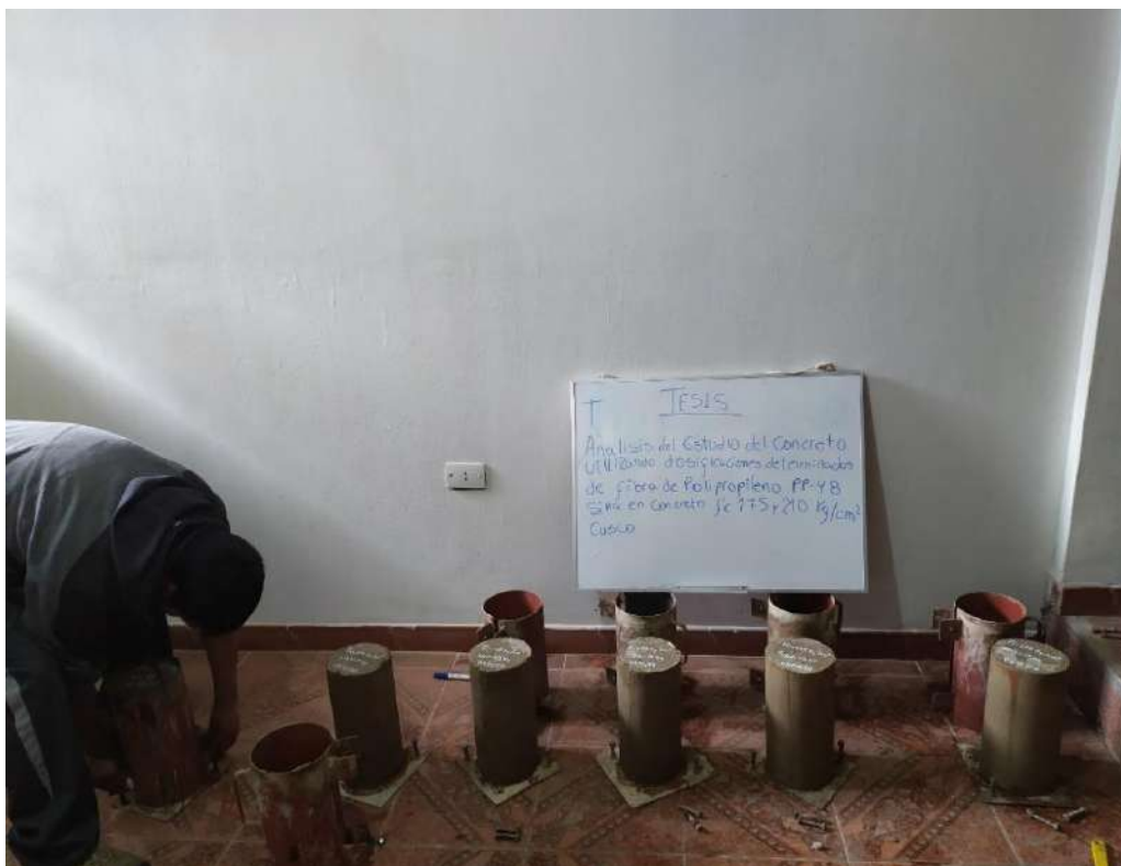
Figura N° 22: Desmoldado de los especímenes Fuente: Elaboración propia
