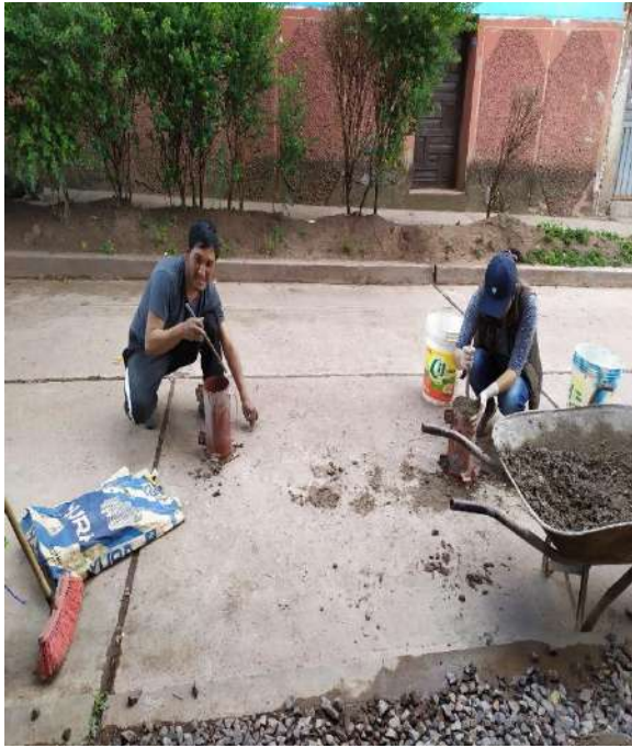
Figura N° 16 y 17: Varillado de especímenes Fuente: Elaboración propia
