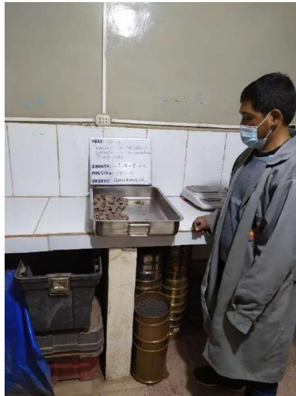
Figura N° 08: Tamizado de los agregados Fuente: Elaboración propia
