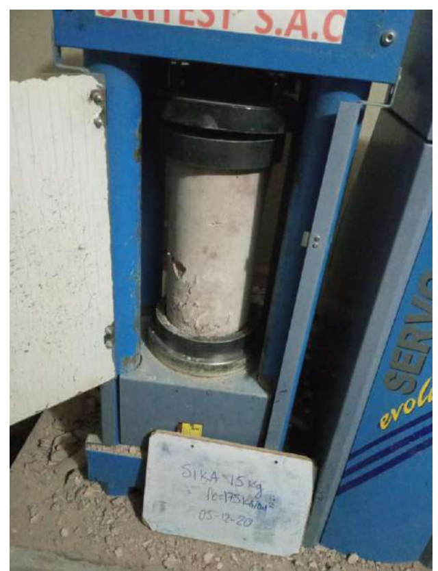
Figura N°23, 24, 25 y 26: Rotura de especímenes de concreto Fuente: Elaboración propia
