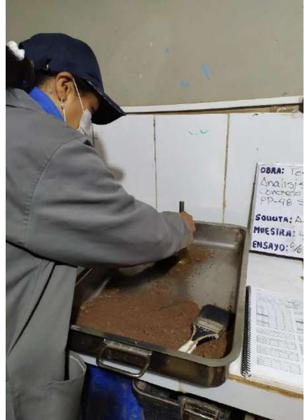
Figura N° 03 y 04: Ensayo de prueba de absorción Fuente: Elaboración propia
