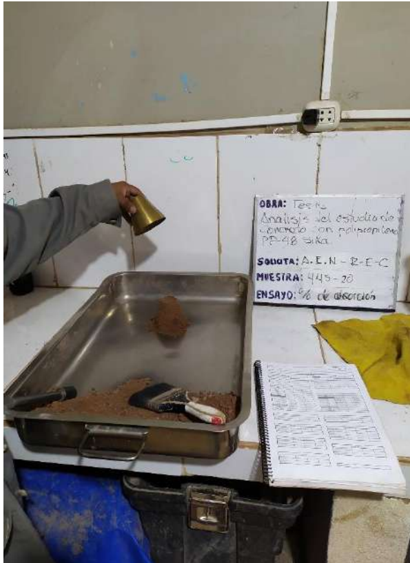
Figura N° 03 y 04: Ensayo de prueba de absorción Fuente: Elaboración propia
