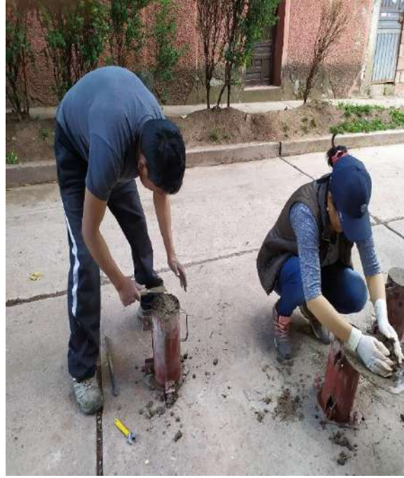
Figura N° 16 y 17: Varillado de especímenes Fuente: Elaboración propia
