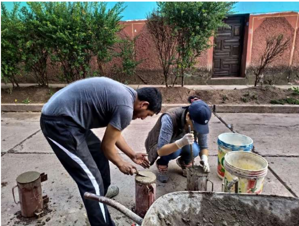
Figura N° 18: Varillado de especímenes Fuente: Elaboración propia
