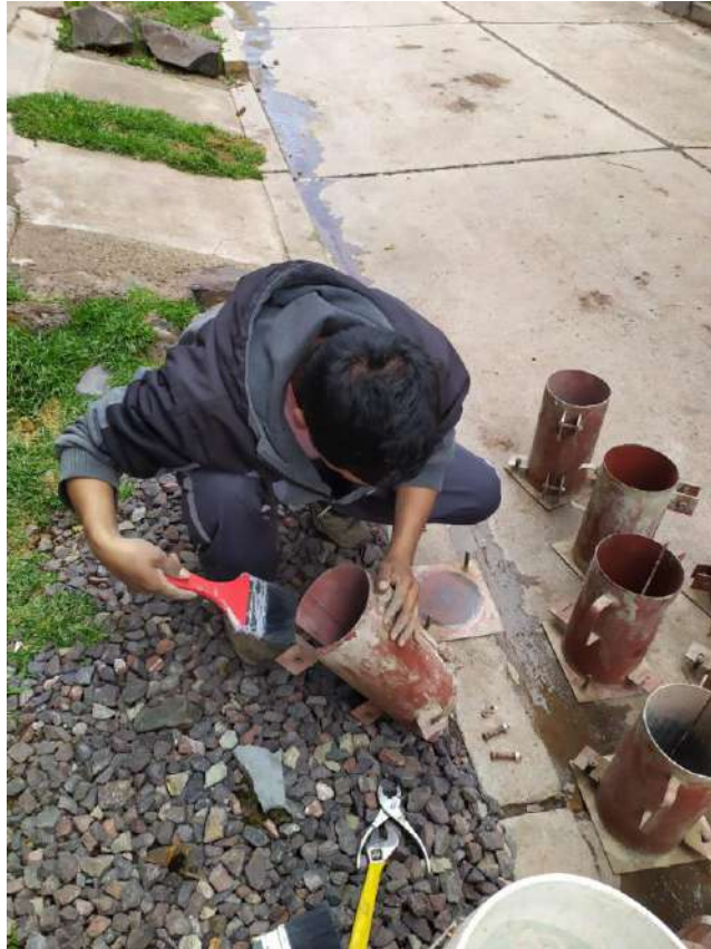
Figura N° 12: Lubricación de las probetas cilíndricas Fuente: Elaboración propia
