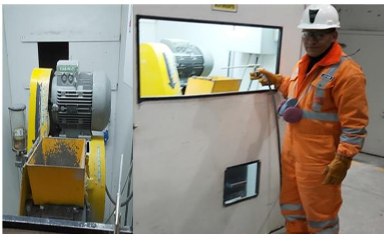
**Figura N° 9.** Chancado del mineral muestreado.
