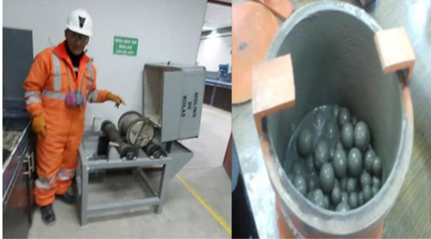
**Figura N° 10.** Molienda del mineral chancado.
