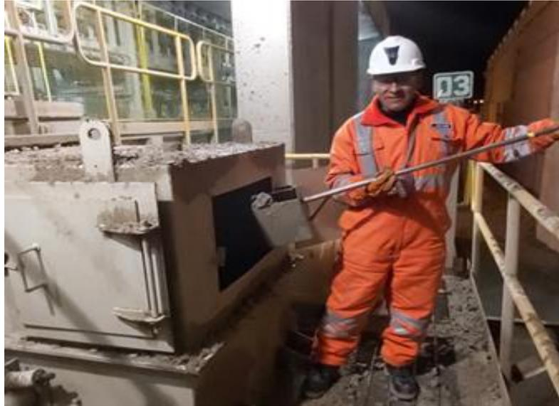
**Figura N° 8.** Muestreo del mineral ingreso al Molino de Barras.
