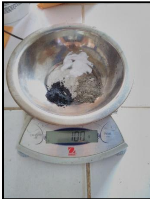
Imagen 17: Pesos para fluorescencia de rayos X y pH del cemento, CBCA, polvo de almeja y combinaciones del 15%.
