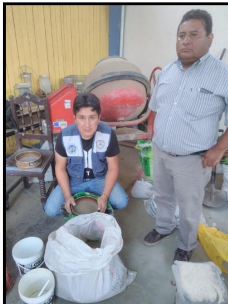
Imagen 10: Gradación del agregado fino por las mallas N° 4, 8, 16, 30, 50, 100, 200 Y plato con la supervisión del ing. Dante Salazar Sánchez.
