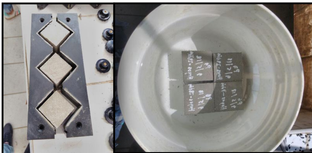
Imagen 20: Desmolde y curado de los cubos de mortero patrón, para curado de 3, 7 y 28 días respectivamente.
