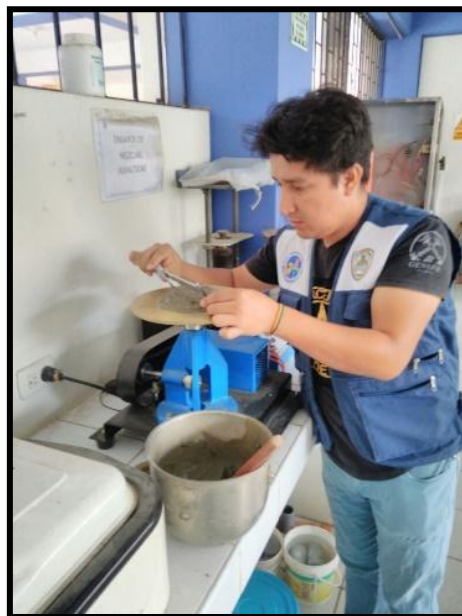
Imagen 18: Ensayo en el fluidímetro electrónico para determinar la relación A/C según NTP 334.051-2013.
