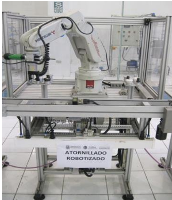
Figura 114. Equipo de atornillado robotizado
