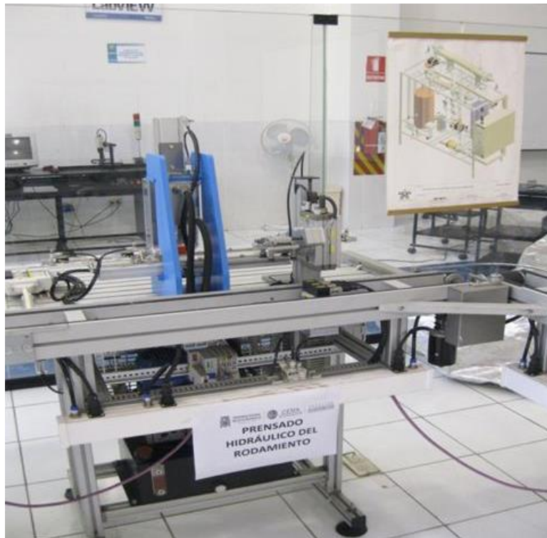
Figura 112. Equipo prensado hidráulico del rodamiento
