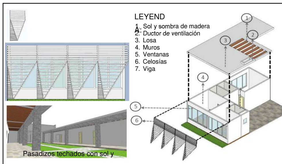
Figura 3811. Zona de internamiento, uso de celosías.
