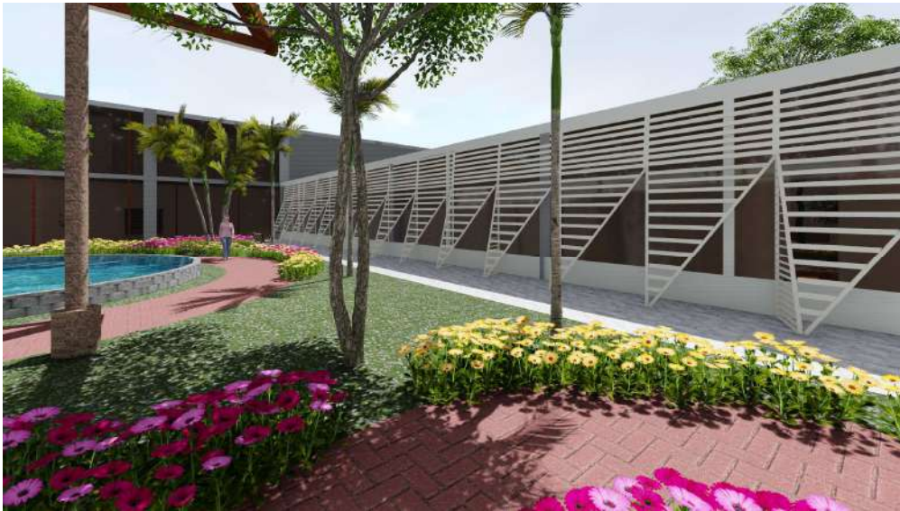
Figura 3912. Elementos de protección solar – Sol y sombra (exterior)
