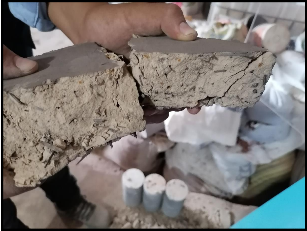
Figura 36. El adocquín de arcilla con adición de fibra de bambú después de ser sometido a la prueba de resistencia a compresión.
