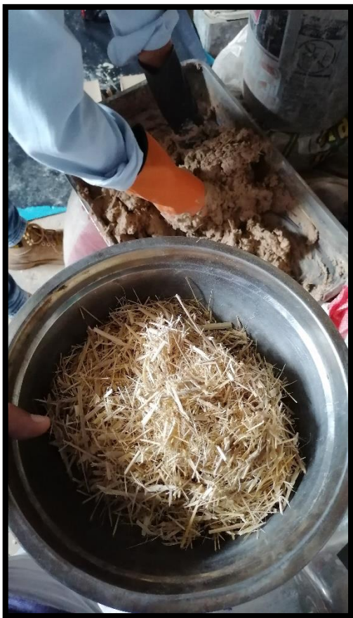
Figura 21. Adición de fibra de bambú a la mezcla para homogenizar los materiales.
