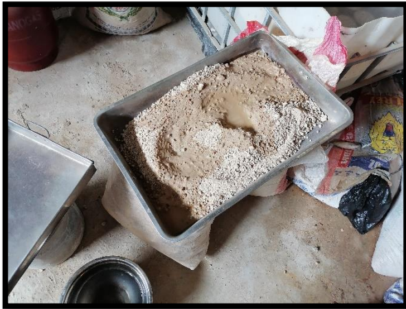
Figura 17. Adición de agua a una humedad óptima.
