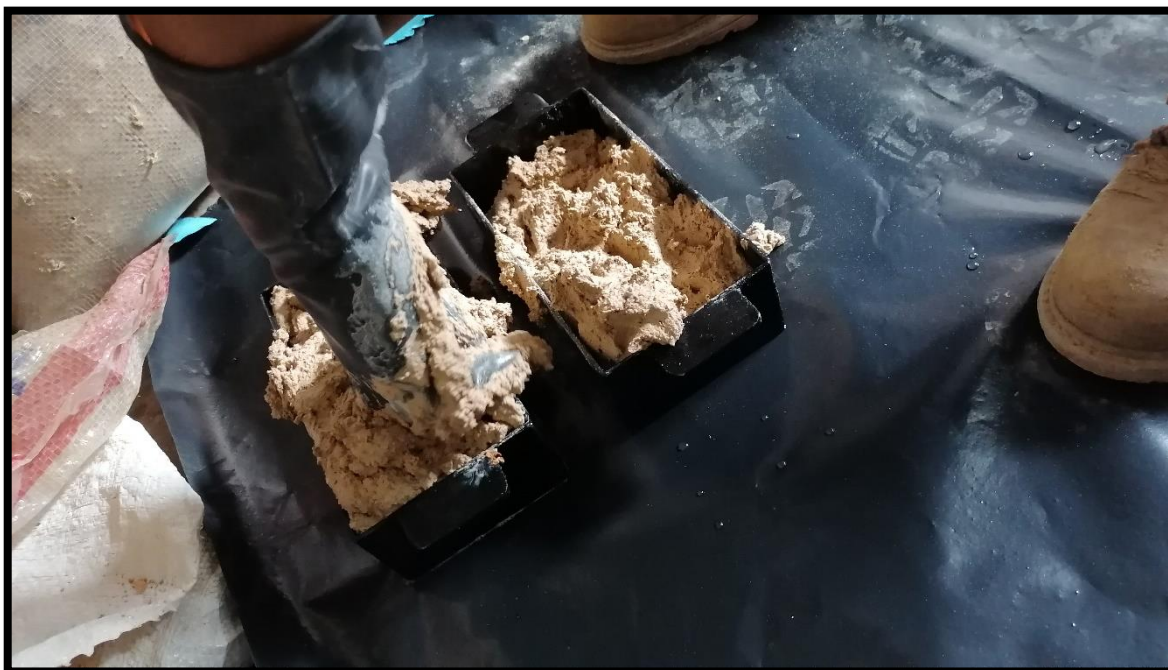
Figura 19. Proceso de moldeo del adoquín.
