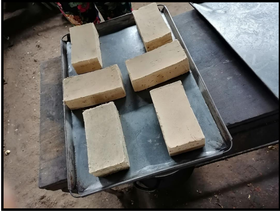
Figura 27. Adoquines sin humedad y listos para proceso de cocción.
