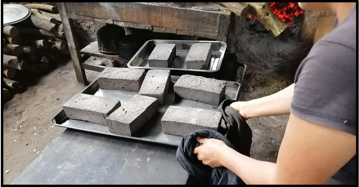
Figura 29. Adoquines de arcilla sometido a cocción por un tiempo de 4 horas.
