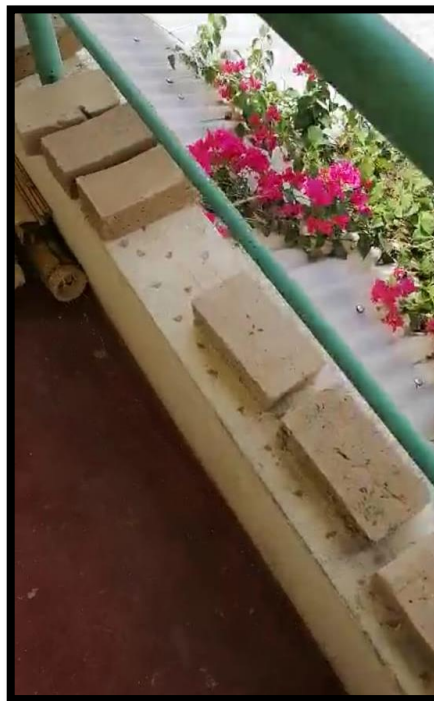
Figura 26. Secado de adoquín de arcilla sin adición y con adición de la fibra de bambú a temperatura ambiente.
