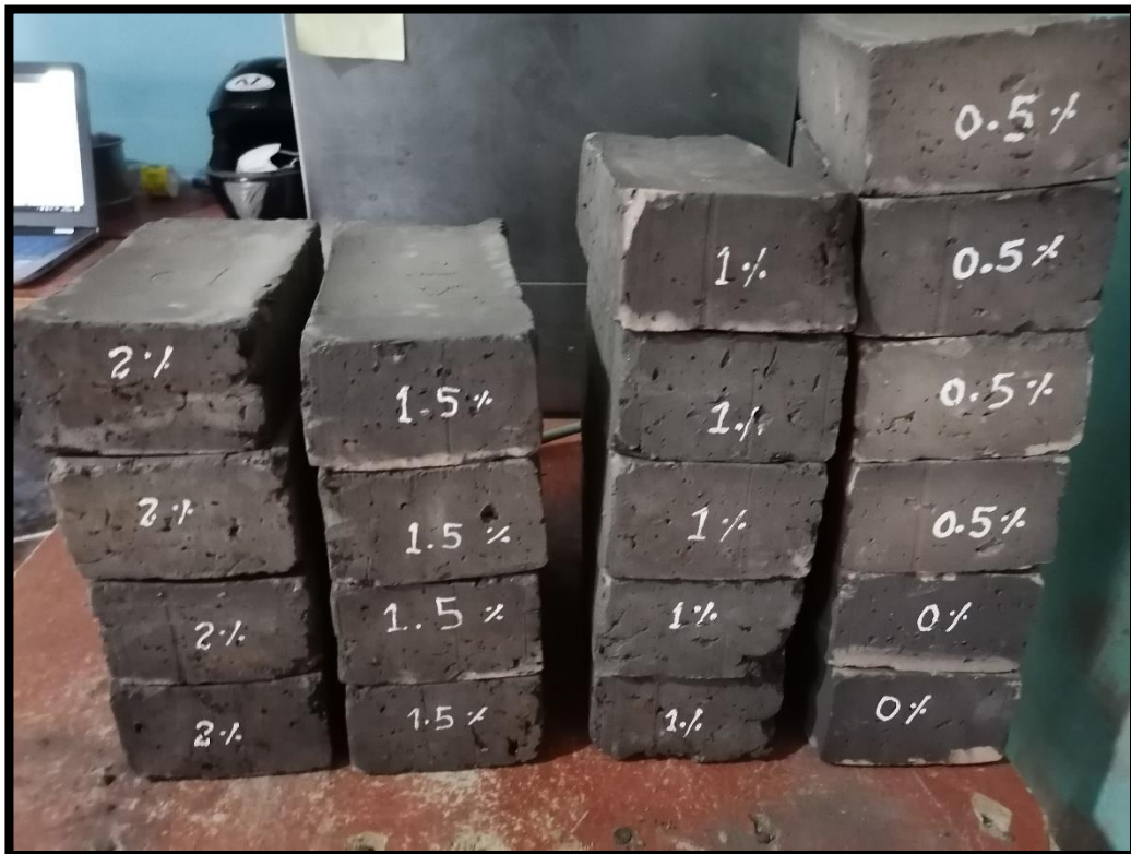
Figura 32. Muestras de adoquines de arcilla cocida sin adición y con adición de fibra de bambú, listos para ser sometidos a estudios de resistencia a compresión.
