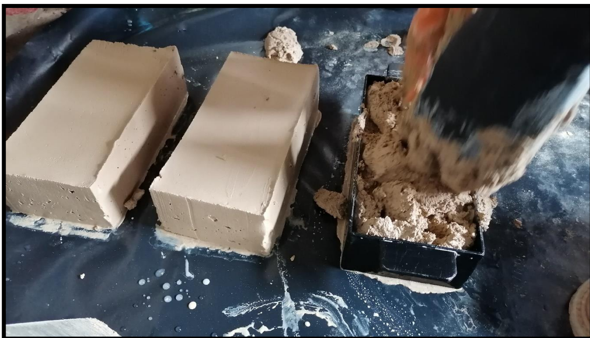
Figura 20. Proceso de desmolde del adoquín.
