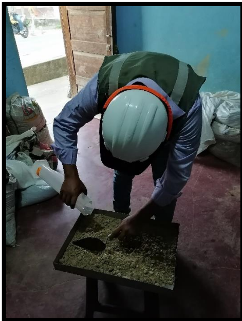
Figura 11. Adición de agua a muestra para ensayo de proctor.
