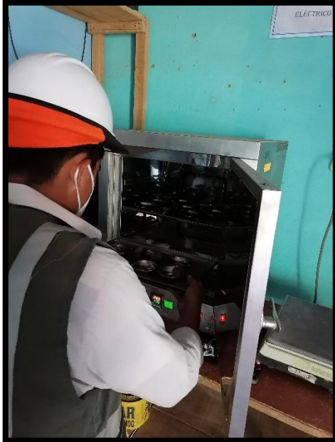
Figura 10. Utilización de Horno eléctrico para límite plástico.
