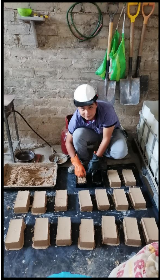
Figura 23. Fabricación de los adoquines sin adición y con adición de fibra de bambú.
