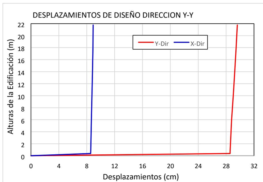
Figura 13: Desplazamientos absolutos del sismo diseñado en el sentido Y-Y
