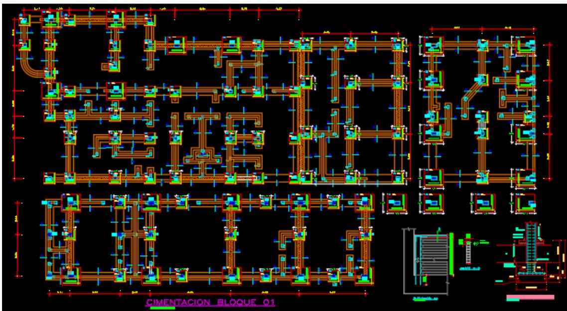
Figura 20: Distribuciones de aisladores de núcleo de plomo
